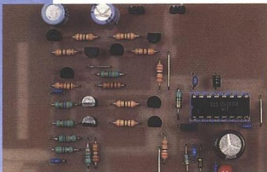
Finalement le signal de sortie est envoyé au buffer vidéo élaboré autour de T9 à T12.
