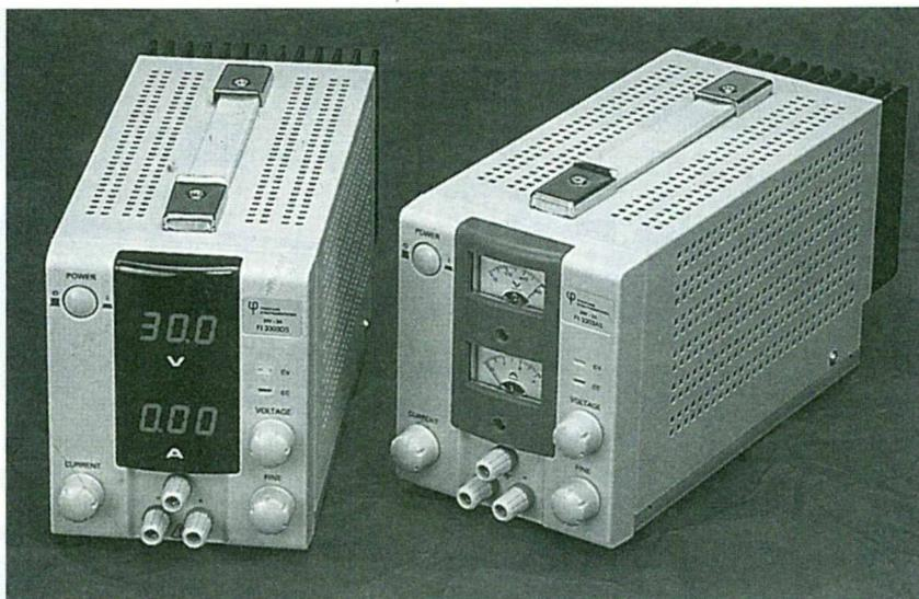
taux) sont grands et bien lisibles et assurent un réel confort d'utilisation. Déclinées en deux séries, ces alimentations sont disponibles avec affichage analogique ou numérique. Deux séries sont proposées : la série 3000 (alimentation simple 30 V, 3A) et la série 6000 (alimentation triple 2 x 30 V 3A, 5V 5A). Il est possible de les mettre en série ou en parallèle avec en plus pour la série 6000 la fonction tracking.
