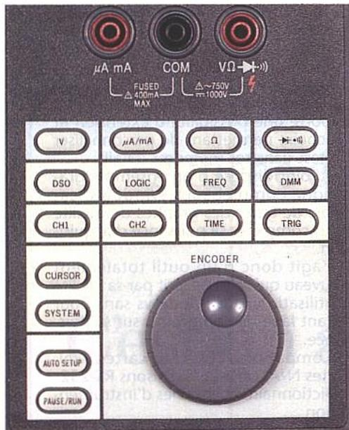
Le panneau de commande très dépouillé et les accès multimètre. L'encodeur sert aux commandes variables dans tous les menus.
