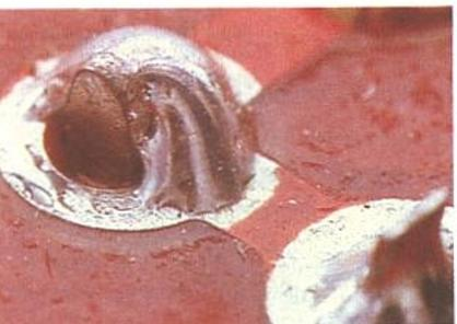
La soudure à l'étain, forme "tendre" de la brasure utilisée dans de nombreux secteurs industriels, met en œuvre un alliage étain-plomb en fusion comme agent d'assemblage devant assurer des liaisons à la fois mécaniques, électriques, et thermiques.
