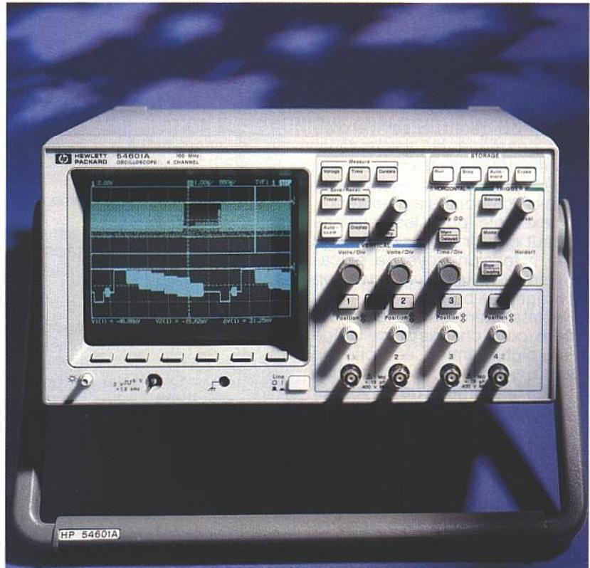
Cette série de scopes numériques comptant à l'heure actuelle deux appareils, les 54600A (2 voies) et 54601A (4 voies), se caractérise essentiellement par une nouvelle conception du panneau de commandes, pour des numériques, et par une architecture innovante qui confère aux appareils une fiabilité élevée tout en simplifiant la circuiterie interne.
