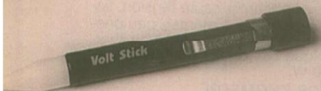
Le Volt Stick est un détecteur de tension alternative sans contact direct. La pointe isolante s'allume instantanément dès qu'elle se trouve à moins de 4 mm d'une tension alternative.
