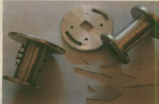
Dépolariseur. A gauche à vis. A droite à lame. Au centre transition circulaire à W7 F5.
