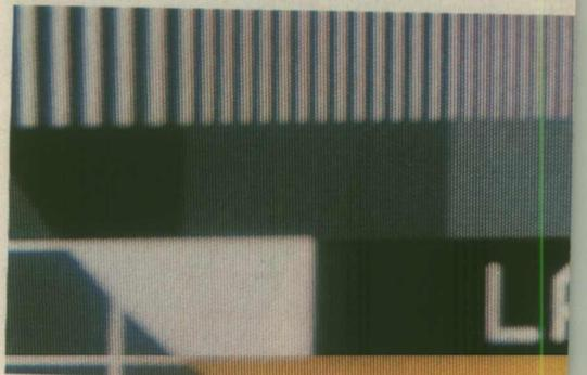
Aspect d'image via démodulateur TECHNI-SAT ST 4000 MAC.
