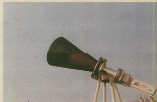
Cornet étalon de 11 cm de diamètre couplé à un convertisseur à 12 GHz dont la figure de bruit est de 0,8 dB, via un système de dépolarisation à vis.
