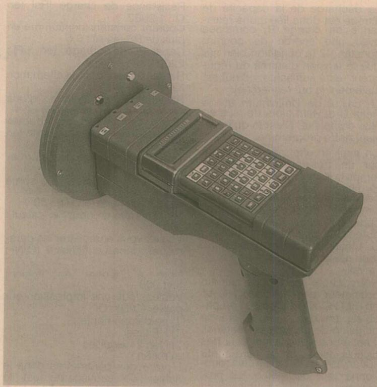
ORDICAM a développé plusieurs types de puces en lecture seule et lecture-écriture de différentes tailles et différentes capacités mémoire. Le transfert des données et de l'énergie nécessaire à la puce se fait par induction ce qui impose l'implantation d'une bobine et des circuits de conversion sur la puce. La fréquence choisie est aux alentours de 125 KHz pour des raisons de conformation aux normes mais pourrait être élevée jusqu'à 500 kHz environ.
