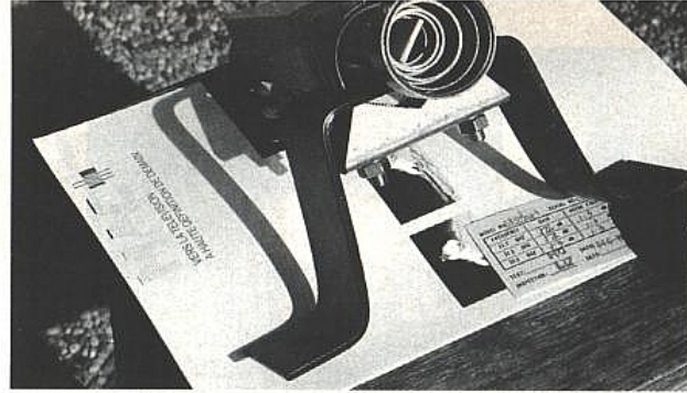
Source cannelée recevant dans sa partie guide d'ondes le dépolariseur (plaquette en téflon placée ici en polarisation gauche).
