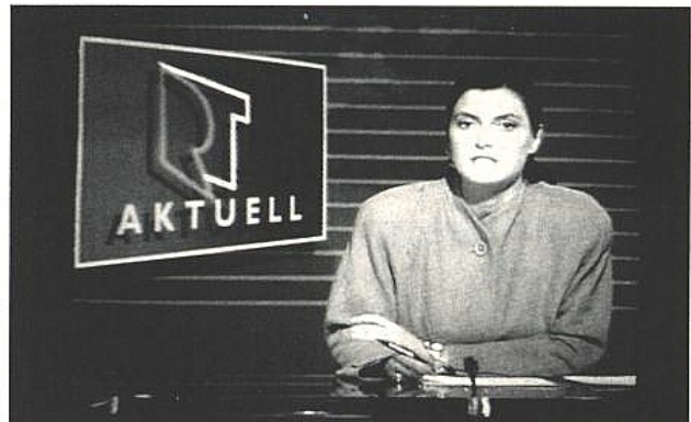
Proche du centre des faisceaux où la PIRE atteint 64 voire 66 dBW, l'emploi de très petites antennes d'un gain de 22 dB, permet d'accéder au service RDS, comme le montre ce cliché.
