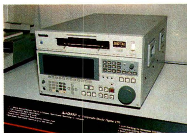
Panasonic : magnétoscope numérique composite D3 (cassette à bande 1/2 pouce).
