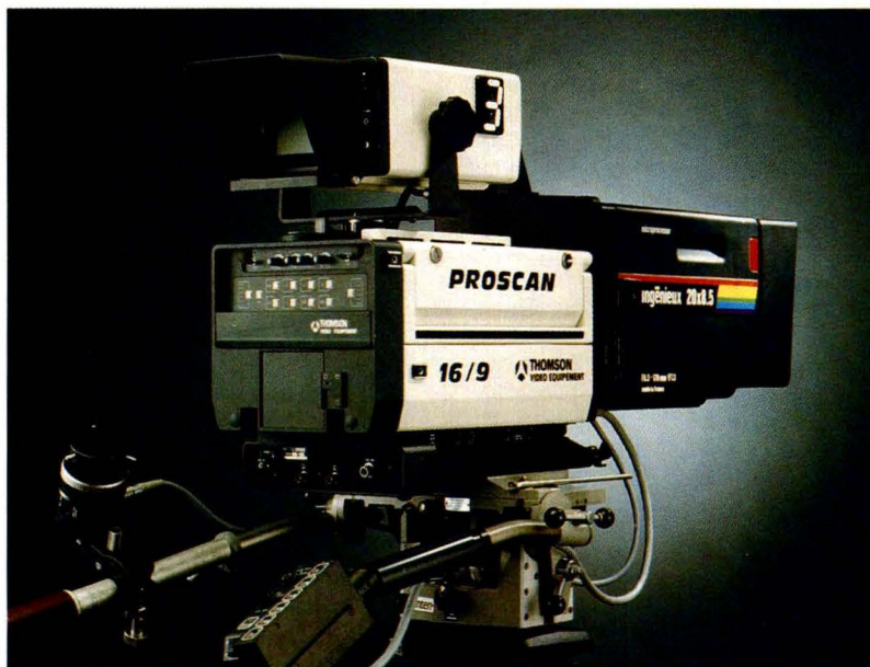
Thomson Vidéo Equipement : Caméra "Pro-Scan" à balayage progressif 625/50/1 ; format 16/9 ou 4/3.
