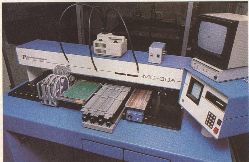
Vue de la machine de placement. L'écran de contrôle à droite permet à l'opérateur d'optimiser le positionnement des CMS sur la plaquette.
