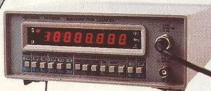
Fréquencemètre de 1 Hz à 1000 MHz. Sensibilité 15 mV. 2 canaux d'entrée. Affichage LED à 8 digits. Mesure de fréquences, périodémètre, totalisateur et contrôle interne.
