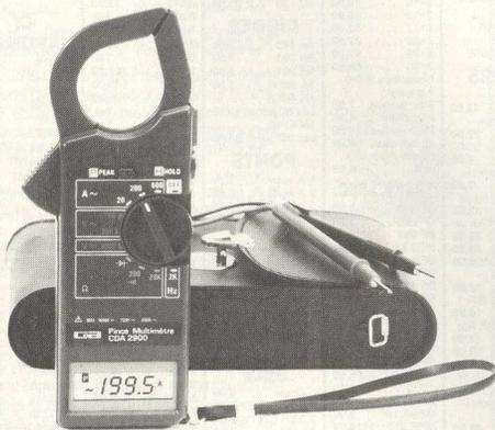
Toutes les fonctions nécessaires aux professionnels de l'électricité sont disponibles sur la **CDA 2900**. Elle offre l'étendue des fonctions d'un multimètre jusqu'à 600 A  $\sim$ , 750 V $\sim$ , 1 000 V..., 20 k $\Omega$  et 2 kHz. Elle dispose aussi du test sonore de continuité et du test diode, des fonctions Valeur Maxi et Mémoire. (Peak et Hold).
