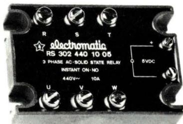
ELECTROMATIC, outre sa gamme traditionnelle de relais statiques allant jusqu'à 90 A, propose désormais des modèles pour commuter des charges triphasées. La commutation de chaque phase est assurée par un alternistor, puce intégrant deux thyristors montés tête-bêche, directement posée sur la base du relais. Les caractéristiques de ce composant lui permettent de commuter des puissances élevées, dans un volume réduit, à partir d'un signal de commande bas niveau.
