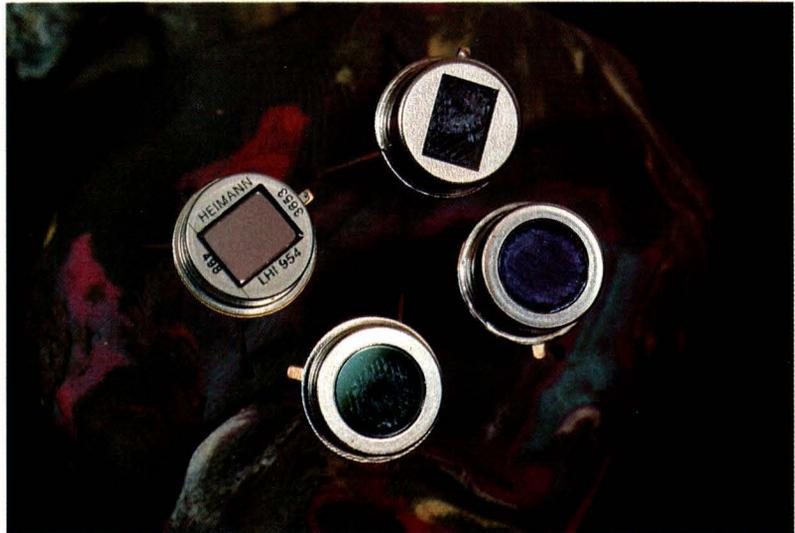
Pour y parvenir, on est conduit à refroidir le détecteur afin de diminuer l'agitation thermique. Les détecteurs fonctionnant suivant ce principe sont très sensibles, mais complexes à mettre en œuvre et donc coûteux.
