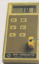
Thermomètre digital 3 digits 1/2. Avec sonde thermocouple K. Mesure de -50° à +1300° C. Résolution 0,1° C et 1° C. Précision 0,2 %. Deux lectures ° C et ° F. Dim. : 130 x 72 x 83 mm
