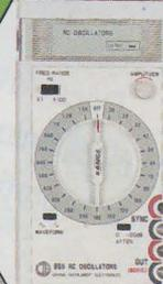
Générateur portable de 20 Hz à 150 kHz échelonnées en 46 fréquences fixes. Sinus et carré. Atténuateur - 20 dB. Taux de distorsion à 15 kHz : 0,05 % à 150 kHz : 0,3 %. Dim. : 150 x 82 x 21 mm
