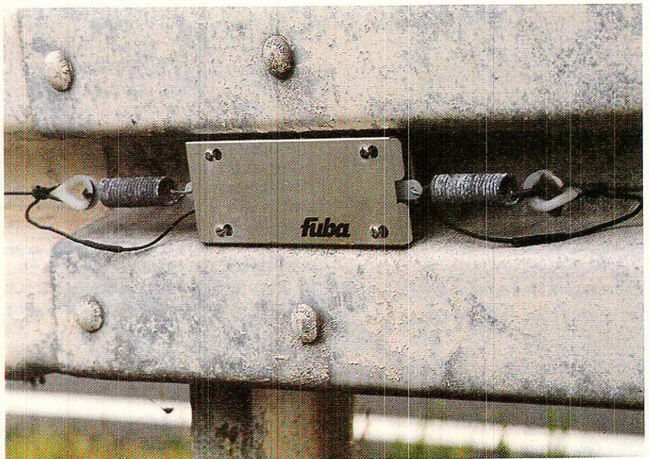
Figure 6 - Amplificateur répéteur.
