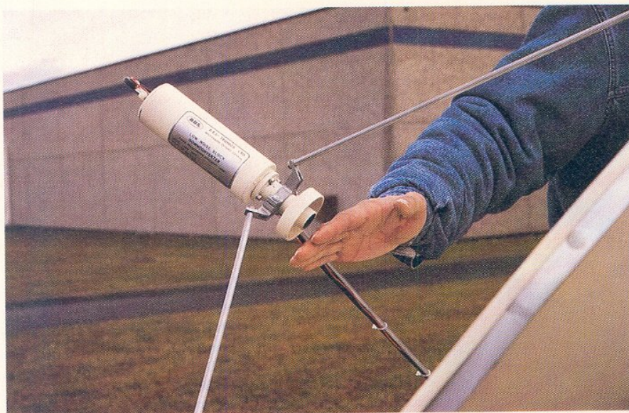
Figure 8 Réglage fin de l'antenne par masquage du cornet.
