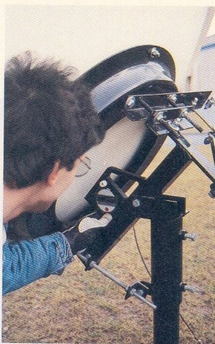
Figure 4 Monture polaire. Vérification de l'inclinaison de l'axe polaire (Documents BEL-TRONICS)
