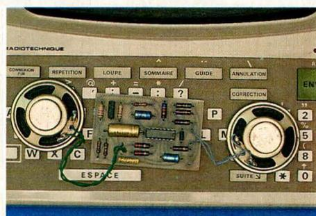
prendre la place des encombrants transformateurs différentiels habituellement utilisés dans les circuits hybrides des postes téléphoniques. Différents avantages en résultent, comme la possibilité de remplacer le micro à charbon par une capsule dynamique plus performante, et comme la facilité avec laquelle les gains d'émission et de réception peuvent être fixés.
