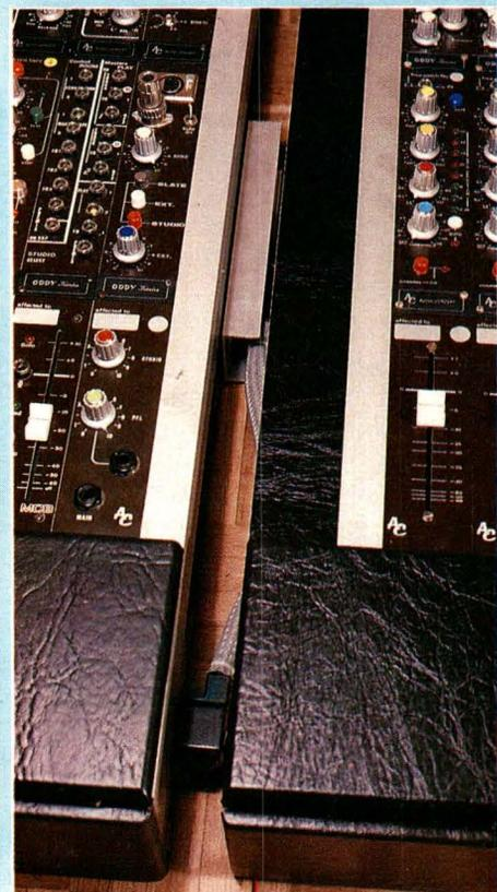
deux trous dans le flanc du châssis pour permettre la liaison. Nous avons pensé au départ à deux rivets, mais cette « nouvelle face arrière » nous a suggéré d'elle-même de la laisser démontable, au cas où... Il est vrai que située dans l'axe du couloir des extensions, de nombreux compléments pourront y aboutir de façon élégante et aisée.
