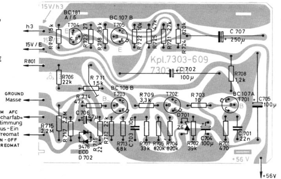
**Endstufenplatte, linker Kanal, Lötseite**
