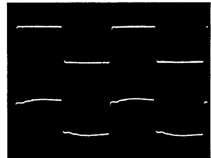
Blokgolf van de Luxman 308. boven in 8Ω, onder in Quad ESL, beide 10 kHz
