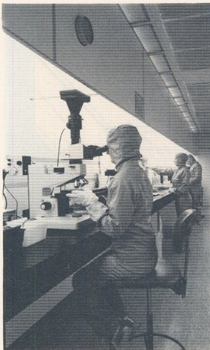
Ligne de photolithographie. Dans ces salles, le niveau de poussières est de 1 ( \phi > 0,5 \mu\text{m} ) par \text{m}^3 d'air.
