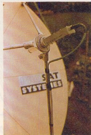
Source et convertisseur (bruit 2dB maxi), en focale sur une parabole d'un gain de 46 dB pour les zones où la P.I.R.E. est proche de 40 dBW (Afrique du Nord Alger — Constantine — Tunis) (PROSAT SYSTEME)
