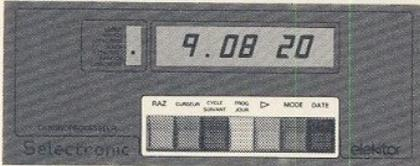
**NOUVELLE VERSION** : - Accordée sur la nouvelle fréquence de France Inter (162,000 kHz) - Compatible avec le nouveau code d'informations (qui sera mis en place de façon définitive le 11/02/87) - Récepteur sans mise au point.
