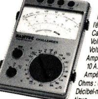
De même philosophie que l'Explorer, le Challenger a été conçu pour l'électronicien. Caractéristiques : Volts continu : 0,25 à 1000 V Volts alternatif : 5 à 1000 V Ampères continu : 25 µA à 10 A. Ampères alternatif : 0,5 à 10 A. Ohms : 0,1 K à 5 M. Décibel-mètre et capacimètre balistique.
