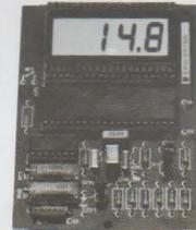
NOUVELLE VERSION GRANDE AUTONOMIE - 55 à + 150 °C. Résolution 0,1 °C (Sans boîtier).
