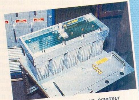
Le coupleur de sortie pour un émetteur 2 kW. On distingue les quatre entrées 500 W en provenance des amplis. La tache blanche en-dessous de la prise de sortie est une résistance du beryllium réalisée en couche épaisse.
