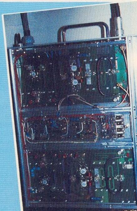
1 module de puissance 500 W ; on distingue à gauche et à droite les deux amplis 250 W et au centre les étages d'attaque.
