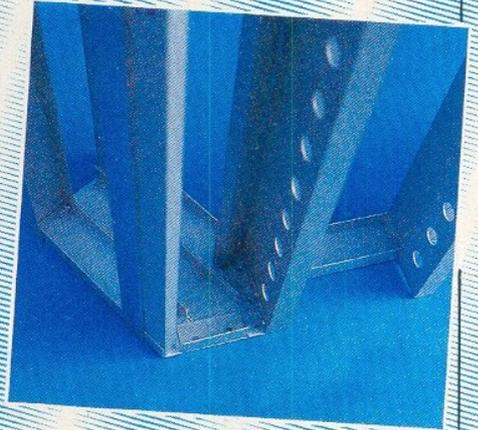
Le bloc arrière vu de dessous (assemblage des flancs inclinés).
