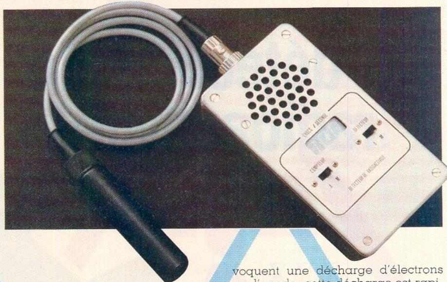
et une électrode centrale qui est l'anode. Les radiations provoquent un déplacement d'ions dans la chambre, elle est alors traversée par un très faible courant, celui-ci est ensuite amplifié par un circuit à très haute impédance d'entrée. Un galvanomètre placé en sortie permet de lire le niveau de radiations.
