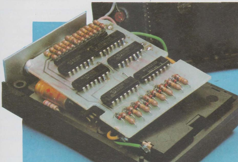
L'option I est sélectionnée en connectant les broches 6 et 7 au + 9 volts.
