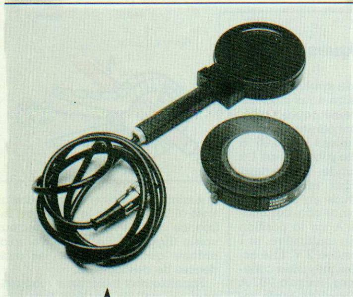
Cellule de l'adaptateur luxmètre, avec l'un des écrans utilisables pour atténuer et introduire une correction d'incidence par diffusion.
