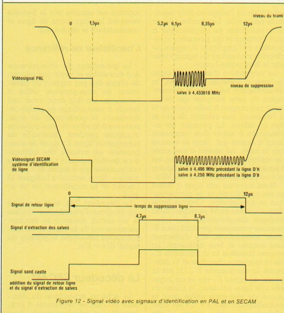
Figure 12 - Signal vidéo avec signaux d'identification en PAL et en SECAM
