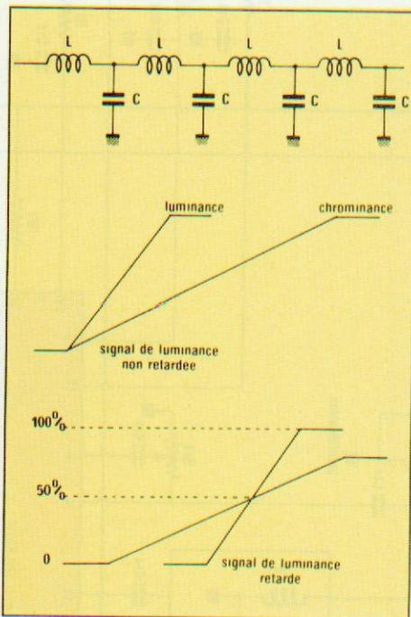
Figure 14 - Schéma équivalent d'une LAR et ses effets
