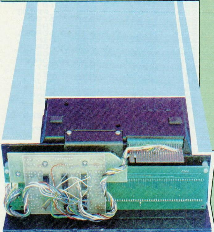
Une simple équerre et deux vis Parker suffisent à fixer rigidement l'afficheur derrière le ZX 81.
