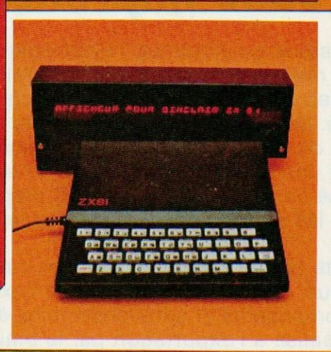
L'ensemble installé dans un boîtier obtenu par pliage à angle droit d'un rectangle de plexiglas fumé.
