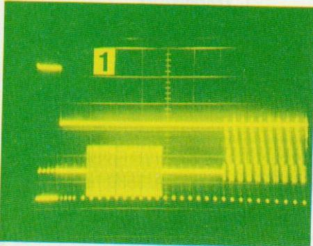
Oscillogramme 1 - Tracé du bas : signaux vidéo Secam avec identification et premières lignes.
