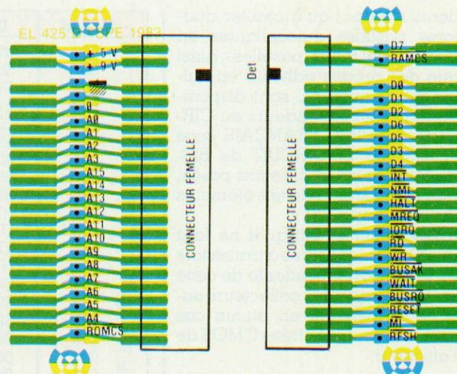
Figure 7 - Tracé du circuit connecteur gigogne et attribution des sorties.
