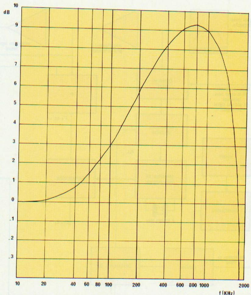
Figure 8 - Courbe de préaccentuation SECAM (voir oscillogramme de fin d'article)
