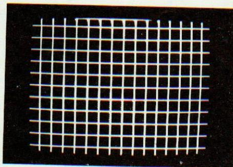
Mire de barres. Sur la photo de droite, on ajoute à la mire de barre, une mire de convergence ; le bandeau pâle est dû à un mauvais choix de la vitesse d'obturation (trop rapide) de l'appareil photo qui met en évidence le balayage entrelacé (une seule trame apparaît à cet endroit).
