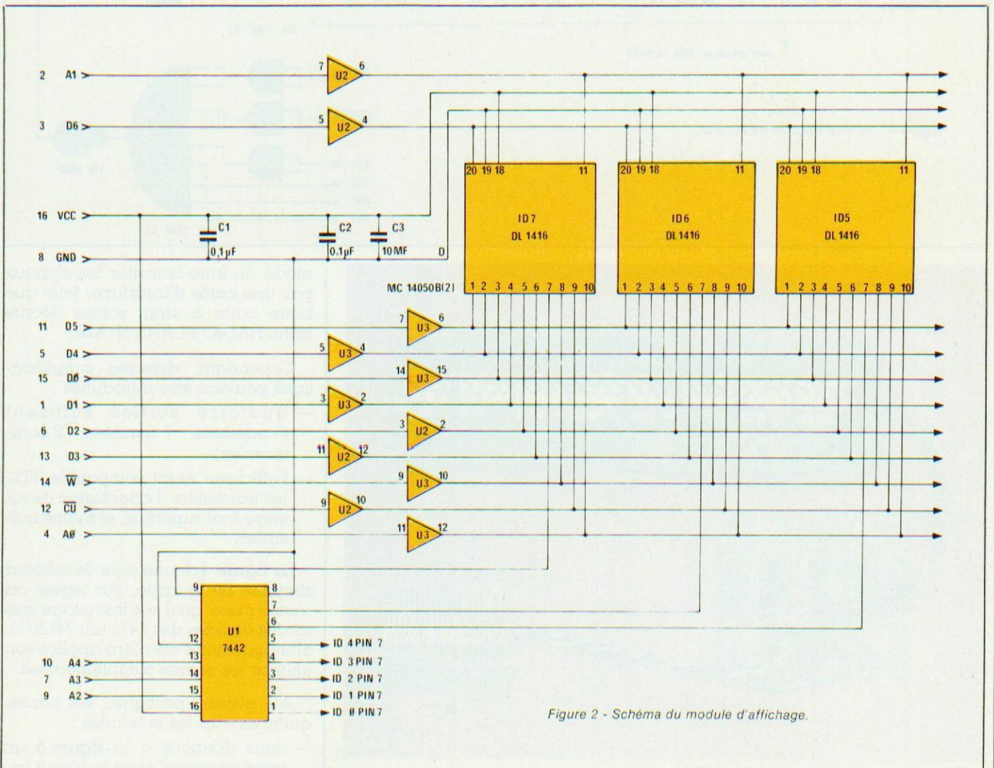
Figure 2 - Schéma du module d'affichage.
