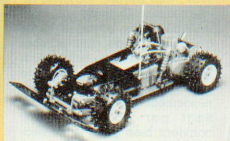
Suspensions avant et arrière et récepteur radio étanche sur cette tout-terrain de Robbe.
