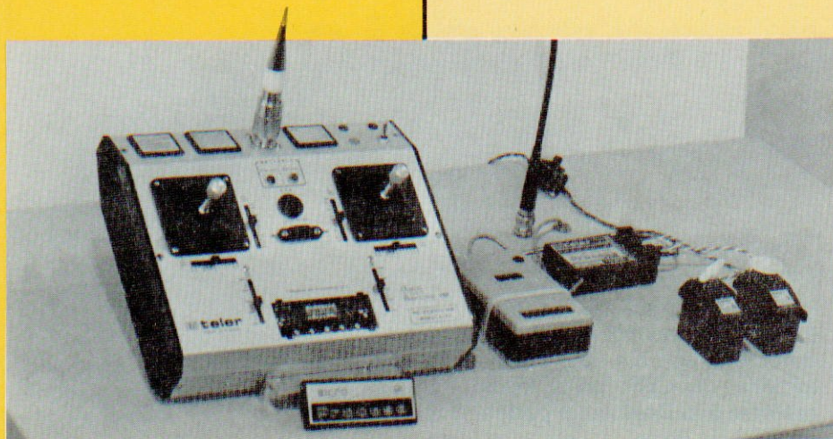
La radio « Absolue ». Synthèse de fréquence, signature radio pour la personnalisation de l'émission et évocation de fréquence.
