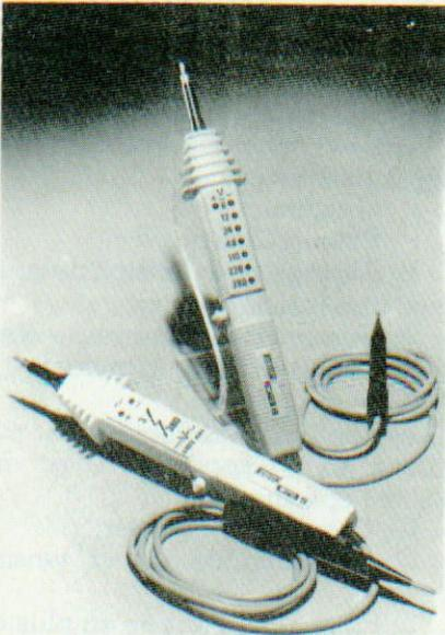
Ces 2 testeurs à semi-conducteurs fonctionnent sans pile et peuvent être utilisés sur des circuits protégés par des différentiels de haute sensibilité.
