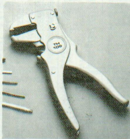
Auto-réglable, cette pince s'adapte d'elle-même sans manipulation, à tous les types de fils, massifs ou câblés, de sections allant de 0,2 mm à 6 mm<sup>2</sup>. Cependant, dans les cas où l'isolant est très tendre, une petite mollette permet de régler la pression des mâchoires sur le fil électrique. Une graduation millimétrique sur la mâchoire inférieure de la pince indique la longueur de fil à dénuder. Un coupe-câble complète l'outil.
