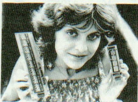
Avec la logique intégrée sur les modules, les afficheurs peuvent indiquer l'état des appareils pilotés par micro-ordinateurs et transmettre des instructions à l'utilisateur. A partir de signaux numériques simples, l'afficheur élabore de véritables messages alphanumériques, aisément lisibles. En outre, de par leur faible tension d'alimentation, 5 V seulement, ces afficheurs sont directement compatibles avec des micro-ordinateurs.
