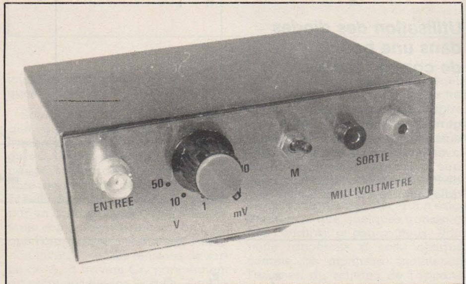
à  $20 \text{ k}\Omega/\text{V}$ , n'offre donc, sur le calibre considéré, qu'une impédance d'entrée de  $20 \text{ k}\Omega$ . Cette impédance s'élèverait à  $200 \text{ k}\Omega$  sur le calibre 10 volts (valeur de  $R_3$ ), mais descendrait à  $2 \text{ k}\Omega$  sur le calibre 100 millivolts (valeur de  $R_1$ ).
