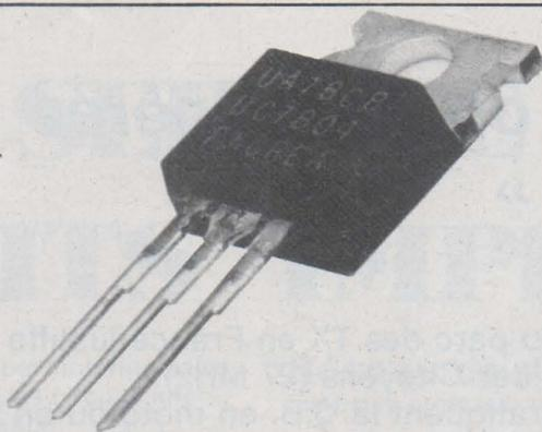
En monolithique, tout le circuit intégré est réalisé sur une même puce de silicium, et le LM 323 représente la limite actuelle de puissance inhérente à cette technologie.
