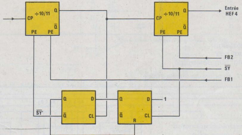
Figure 13 : Régénération du signal SY par 2 prédiviseurs ECL.
