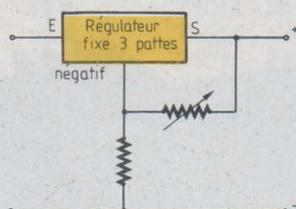
Figure 1c : Régulateur « 3 pattes » ajusté.
