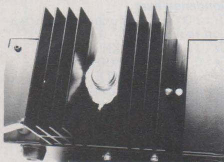
En glissant une gaine incombustible sur ces trois fils (la gaine tissu ou toile imprégnée est excellente), on peut alors placer le radiateur équipé sur la face arrière, puis le fixer avec deux vis de 3 mm ou 4 mm de façon définitive. Le passe-fil en caoutchouc terminera la face arrière. Placer alors ce châssis sur le fond partiellement câblé pour l'interconnexion finale.
