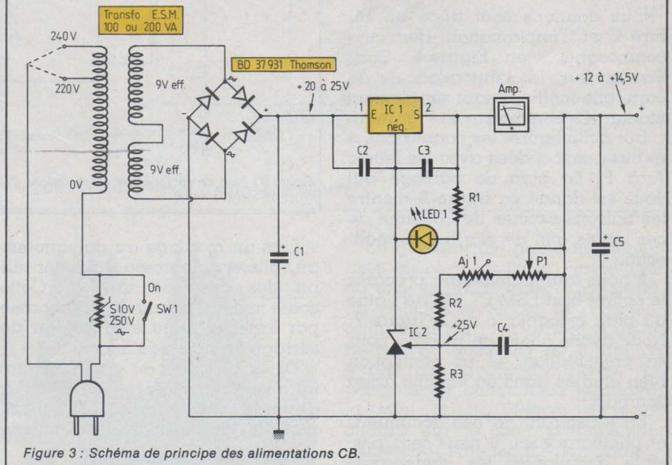
Figure 3 : Schéma de principe des alimentations CB.
