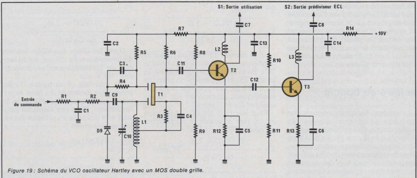
Figure 19 : Schéma du VCO oscillateur Hartley avec un MOS double grille.
