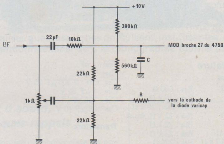
Figure 32 : modulation de fréquence et de phase.
