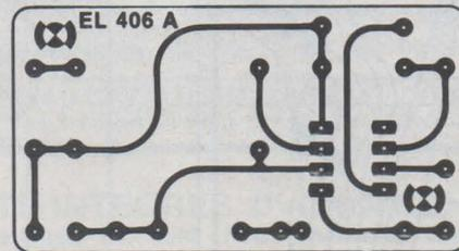
Figure 4 : Tracé du circuit imprimé.
