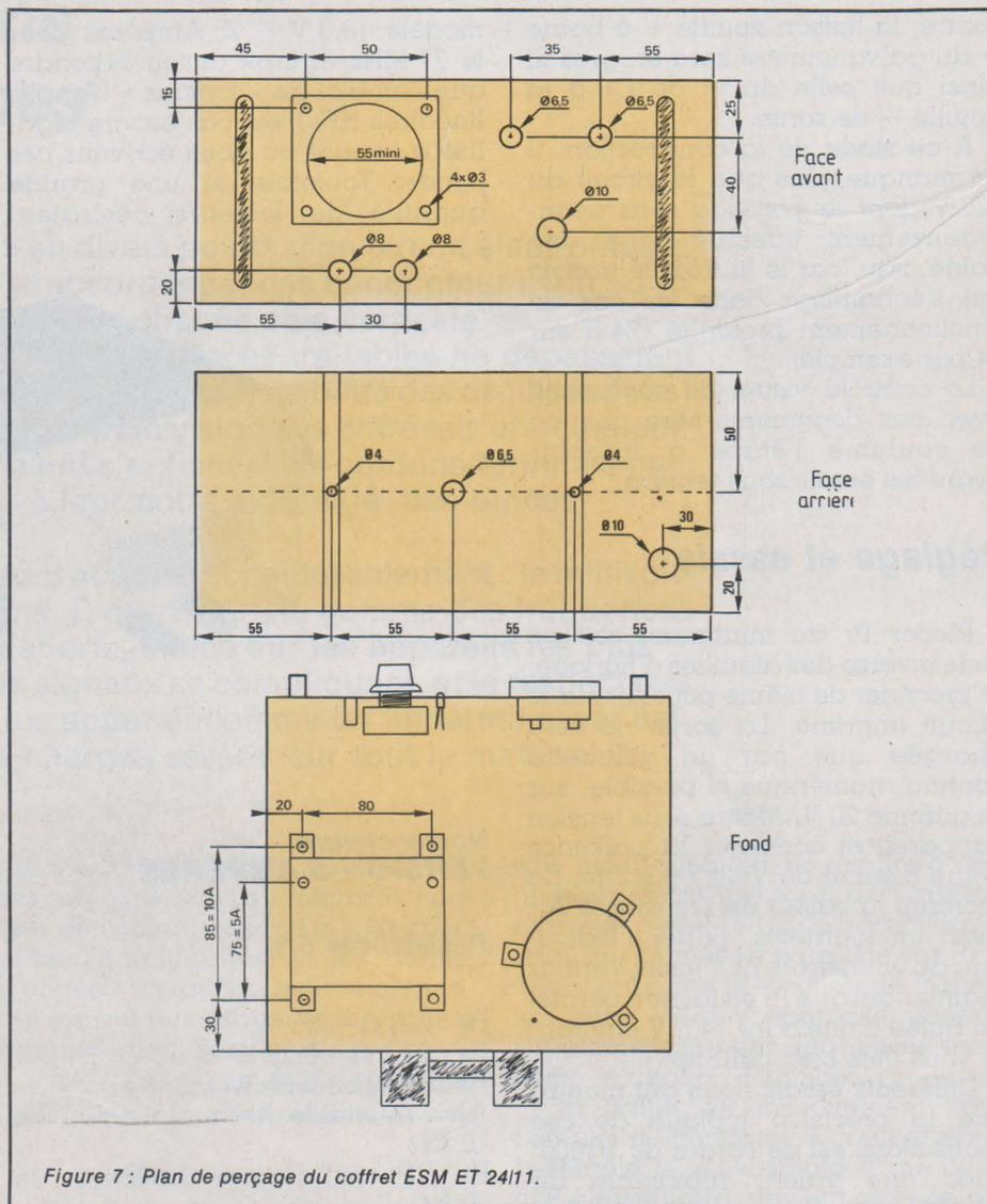
Figure 7 : Plan de perçage du coffret ESM ET 2411.
