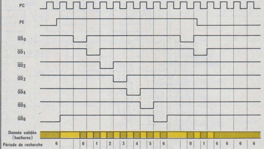
Figure 14 : Diagramme des temps des entrées programme :
