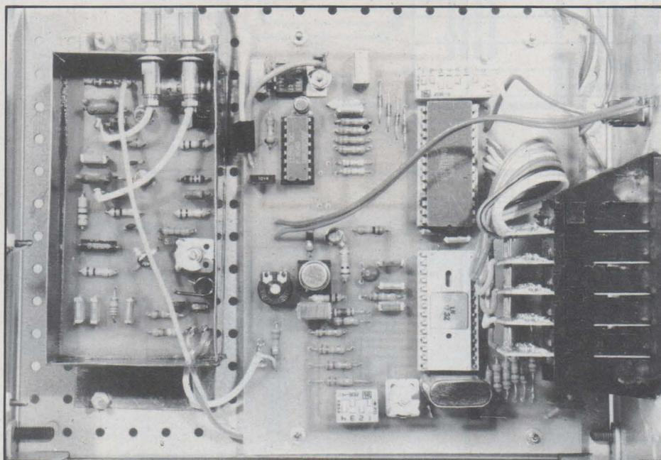
entrée de l'ampli d'erreur reçoit une fraction de la tension de sortie. Le potentiomètre  $R_{51}$  permet le réglage de la tension de sortie, 10 V dans notre cas.
