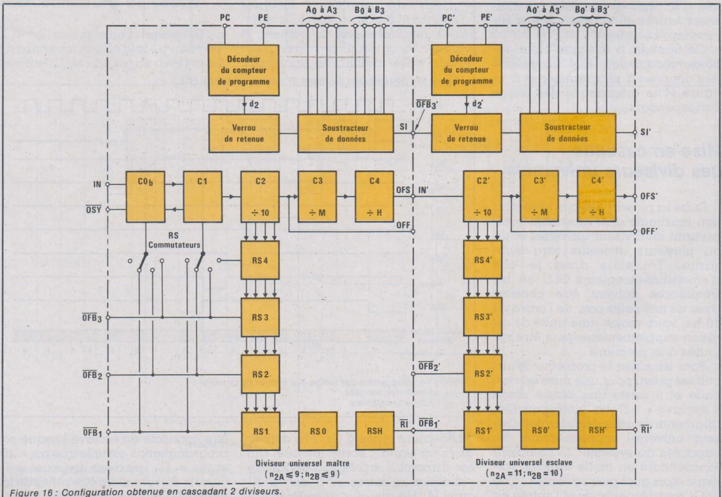
Figure 16 : Configuration obtenue en cascade de 2 diviseurs.
