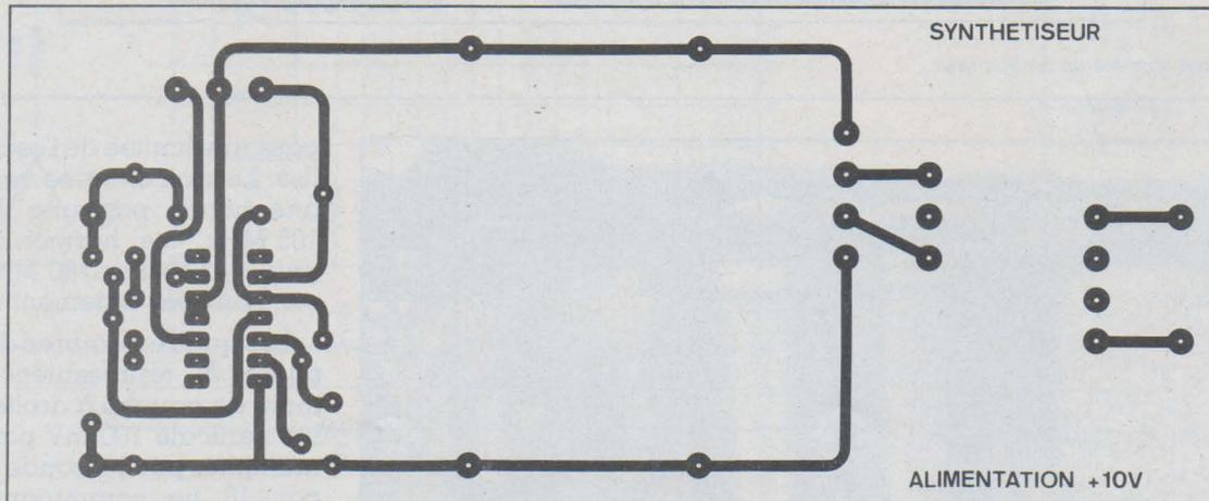
Figure 30 : tracé des pistes de l'alimentation.
