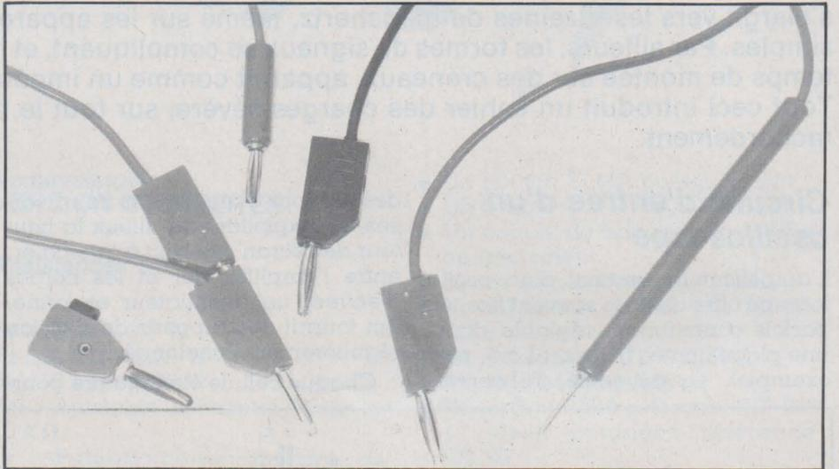
Notons au passage que l'électronicien s'épargnera bien des crises nerveuses, par un choix judicieux des cordons équipant son laboratoire. On préférera notamment les prises à la fois mâles et femelles, qui facilitent les branchements multiples. Pour les connexions provisoires sur fils souples, les prises rapides fournissent une solution idéale. Tous ces matériels sont visibles à la figure 5.
