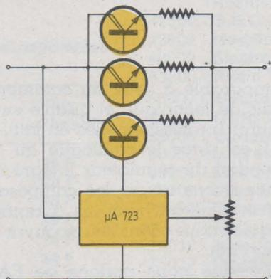
Figure 1b : 723 avec ballast en parallèle.
