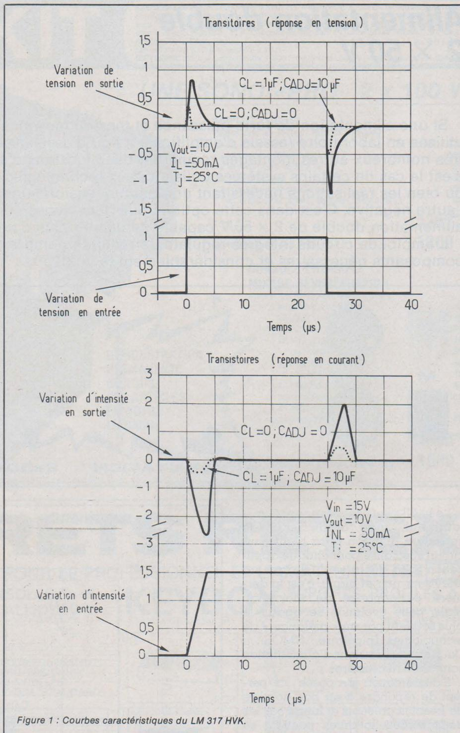
Figure 1 : Courbes caractéristiques du LM 317 HVK.
