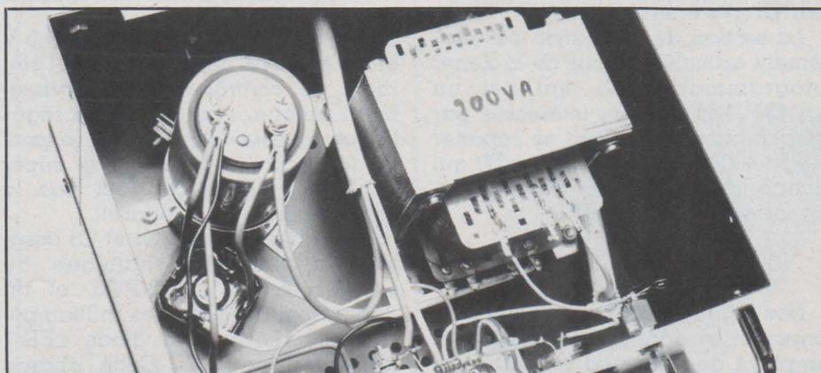
par le montage d'un supprimeur SIOV 07-K-250 sur les contacts actifs de l'inverseur marche-arrêt. La face avant ainsi équipée peut maintenant être montée sur l'assemblage face arrière + parois. Ce châssis est provisoirement mis de côté.
