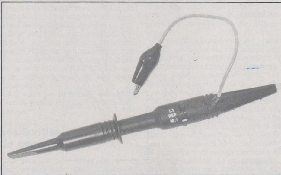
câble coaxial, et de l'impédance équivalente de l'oscilloscope associé. Celui-ci présente une résistance d'entrée  $R_e$  (généralement égale à  $1\text{ M}\Omega$ ) en parallèle sur une capacité  $C_e$ , voisine, comme nous l'avons déjà dit, de  $30\text{ pF}$ . A  $C_2$ , s'ajoute la capacité du câble : nous la supposons de  $100\text{ pF}$ , pour situer un ordre de grandeur réaliste.
