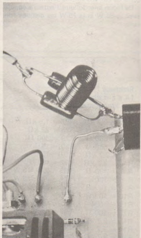
Vue de la self : on distingue nettement les deux couches des spires.
