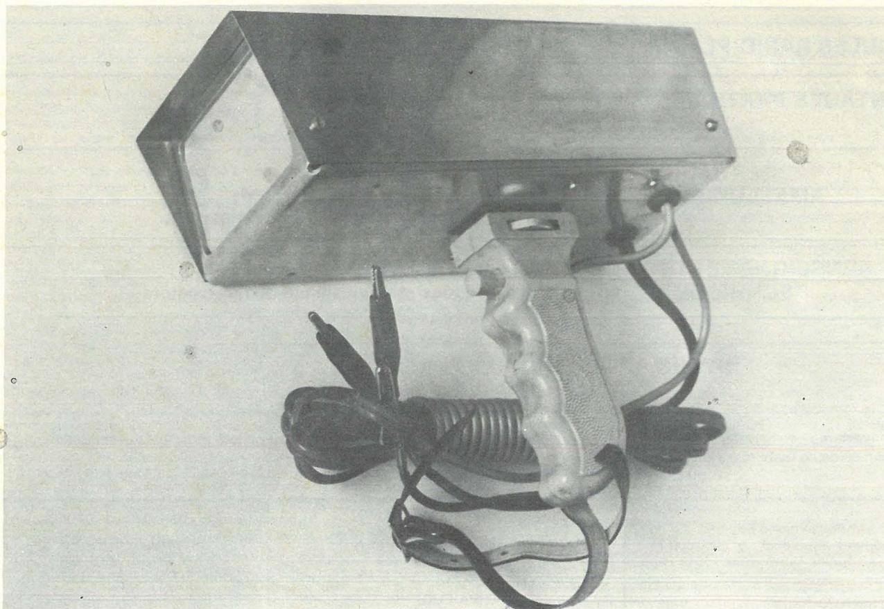
Ce stroboscope, alimenté en 12 volts continus peut être synchronisé par les impulsions d'allumage d'un moteur à explosions et convient donc parfaitement pour réaliser une mise au point précise de l'avance, au ralenti ou en régime plus élevé. Doté d'un générateur d'impulsions propre, on dispose d'un stroboscope classique opérant de 10 à 100 Hertz environ. Enfin un tachymètre permet de mesurer la fréquence du générateur interne ou bien de déduire la vitesse de rotation du moteur.
