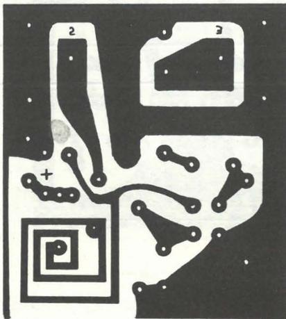
Figure 8 : Circuit imprimé préamplificateur FM.
