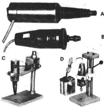
**P 2** (fig. A). Type professionnel, long. 180, Ø 38 mm 9 à 18 volts continu, 16.500 t/m, couple 350 cm/g, mandrin permettant un serrage de 0 à 3,5 mm. La perceuse seule, avec ses 4 pinces de mandrin. Prix ..... 141,00 + port et embal. 7,00.
