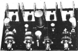
Entièrement câblé et pré réglé, dim. 185 x 130 x 55 mm, équipé des potentiomètres vol/gr/aig/bal, ainsi que du circuit d'alim. (redresseurs + filtres), prévu pour recevoir du 2 x 28 volts alt., sensib. d'entrée 25 à 150 mV (P.U. crist. ou tuner), rép. 38 à 18.000 Hz, impéd. de sortie 8 ohms ..... 161,00
