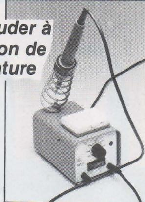
L'ensemble de soudage Iskra THS 11 comporte un fer d'une puissance maximale de 60 watts, et un dispositif de réglage et de régulation de la température de la panne, fonctionnant dans la plage de 180° C à 420° C. Le transformateur incorporé assure l'isolement galvanique entre le secteur et les circuits d'utilisation. L'appareil est prévu pour une tension primaire de 220 volts ( $\pm 10\%$ ), et le fer travaille sous 24 volts.
