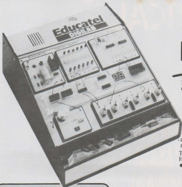
Le DIGILAB, pupitre d'expérimentation digitale, renferme 6 appareils câblés sur un circuit imprimé :
