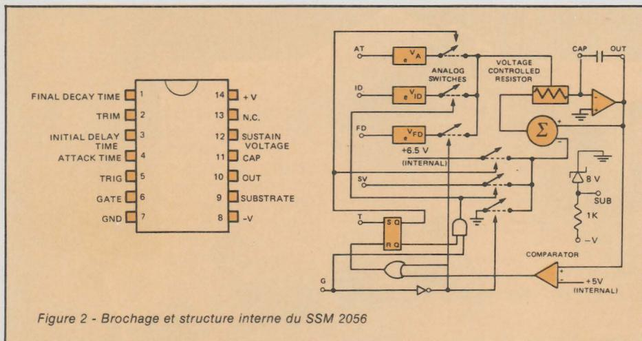
Figure 2 - Brochage et structure interne du SSM 2056
