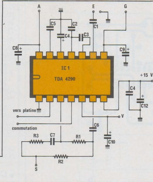
Figure 13 - Schéma de principe correcteur de tonalité.
