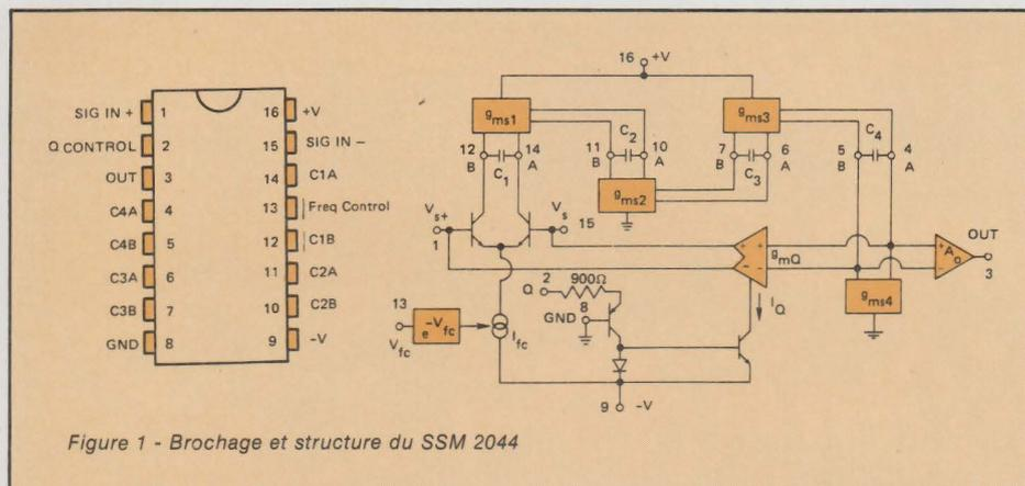
Figure 1 - Brochage et structure du SSM 2044
