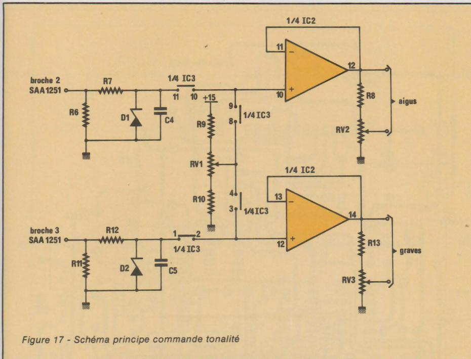
Figure 17 - Schéma principe commande tonalité
