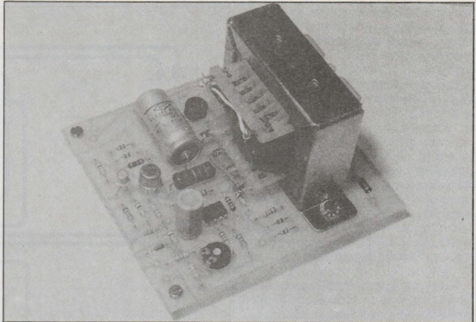
C'est l'intensité qui, finalement, charge la batterie à travers  $D_3$ . On peut l'ajuster finement par  $R_2$ , en cas de nécessité. On sélectionne essentiellement sa valeur par  $R_1$ . Avec les composants énumérés en nomenclature, on dispose de 500 mA. D'autres valeurs s'obtiendraient en modifiant, ou en commutant, la résistance  $R_1$ .
