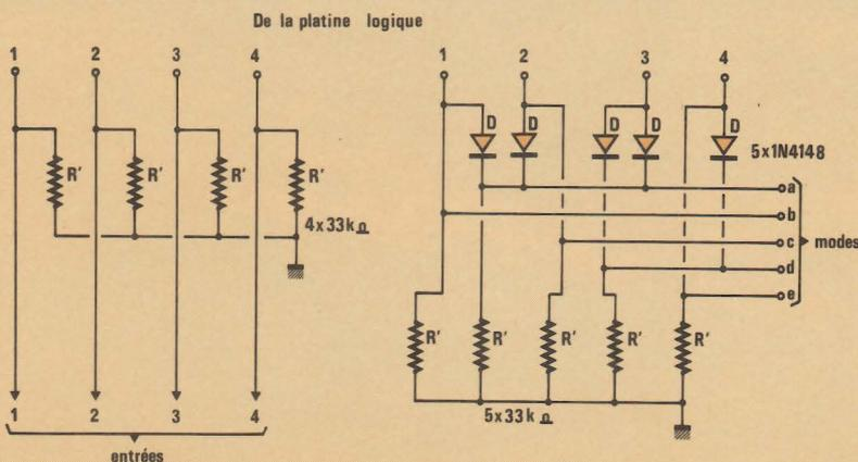
Figure 8 - Commande des portes CD 4066
