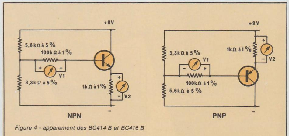
Figure 4 - apparement des BC414 B et BC416 B
