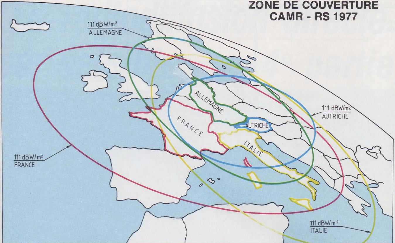
Figure 1 - Empreintes au sol -111 dBW/m<sup>2</sup> émis par les satellites des principaux radiodiffuseurs Européens ayant obtenu des allocations comportant une position comparable à TDF 1 à savoir 19° Ouest.
