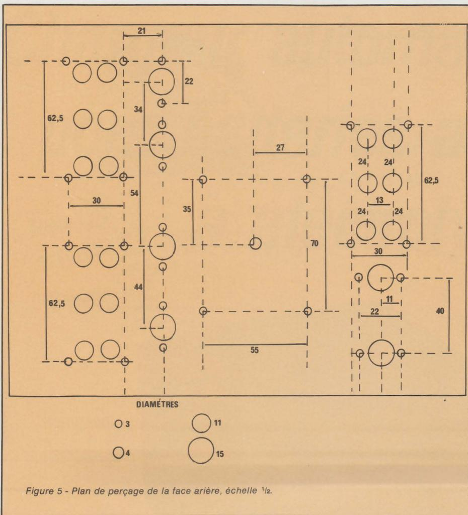
Figure 5 - Plan de perçage de la face arrière, échelle 1/2.
