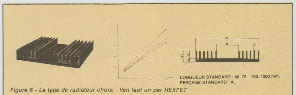
Figure 6 - Le type de radiateur choisi : Il en faut un par HEXFET
