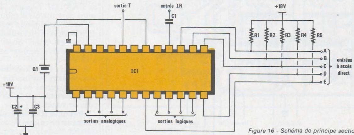
Figure 16 - Schéma de principe section décodage
