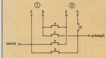
100 dB. La troisième porte est obligatoire pour éviter de mettre l'entrée du circuit suivant en court-circuit. Si l'impédance de charge sur  $V_s$  est de  $10\text{ k}\Omega$ , le rapport dû à la porte c est de 1000 cf (a). On arrive donc à un rapport total de  $10^3 \times 10^5 = 10^8$  soit 160 dB.
