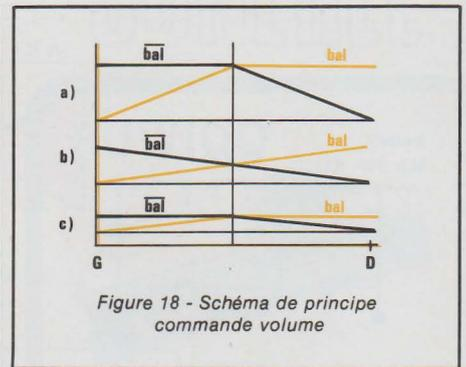
Figure 18 - Schéma de principe commande volume
