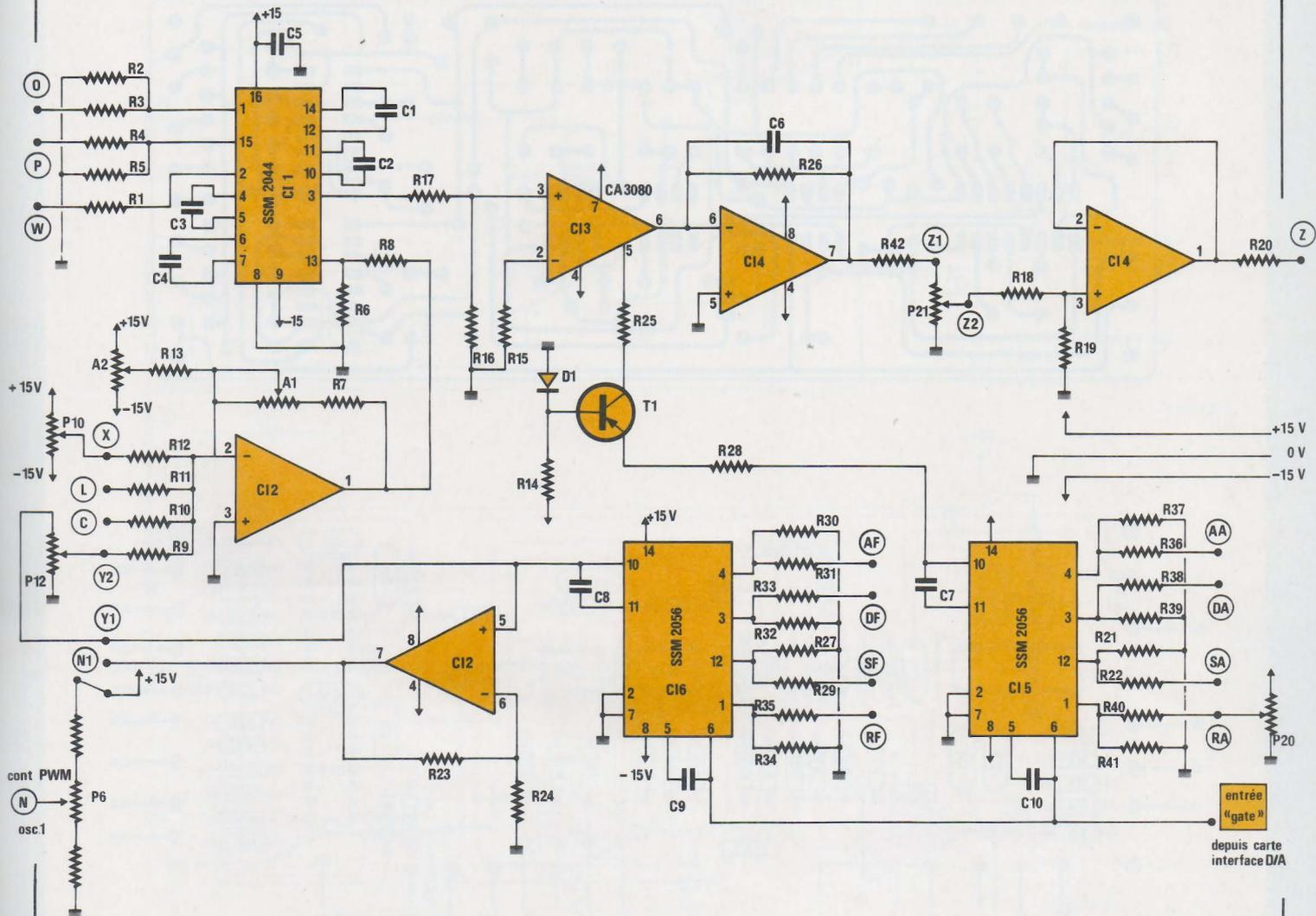
Figure 3 - Schéma de principe filtre enveloppes atténuateur
