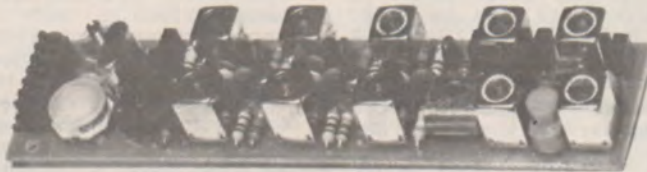
Platine HF conseillée pour être utilisée avec le codeur 7 voies LEXTRONIC ci-dessous
