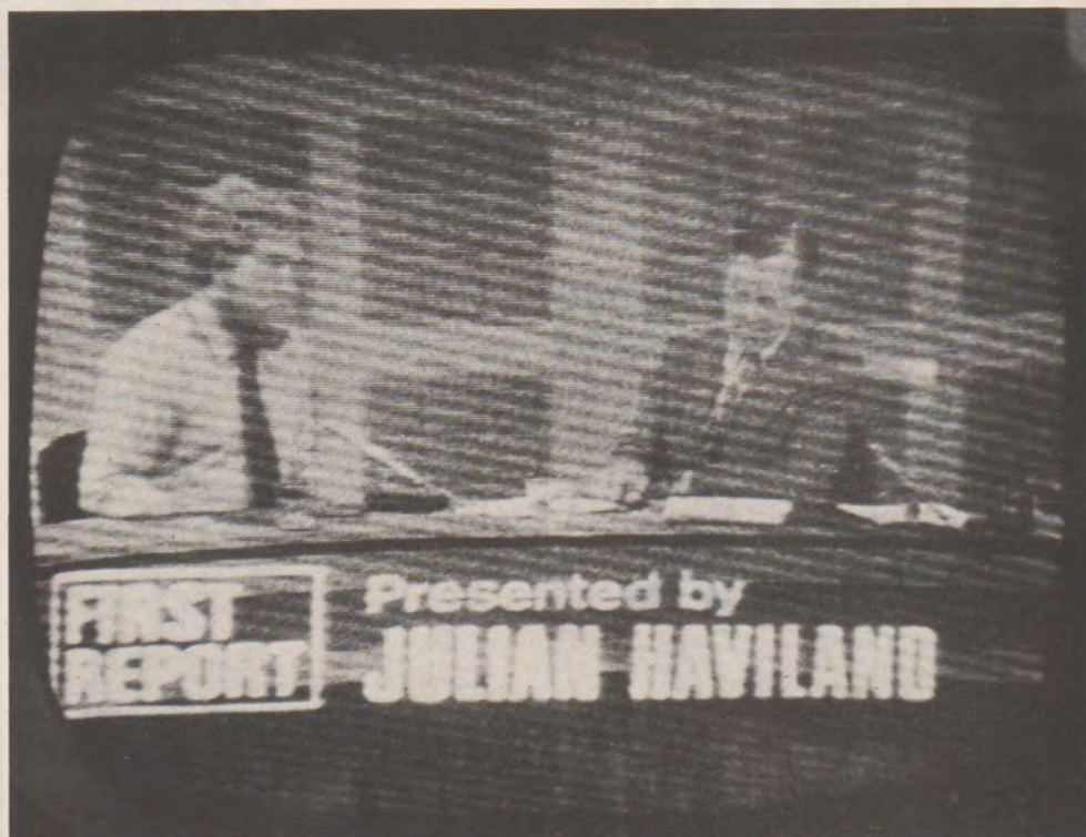
Interférences causées par un second émetteur travaillant sur une fréquence très voisine.
