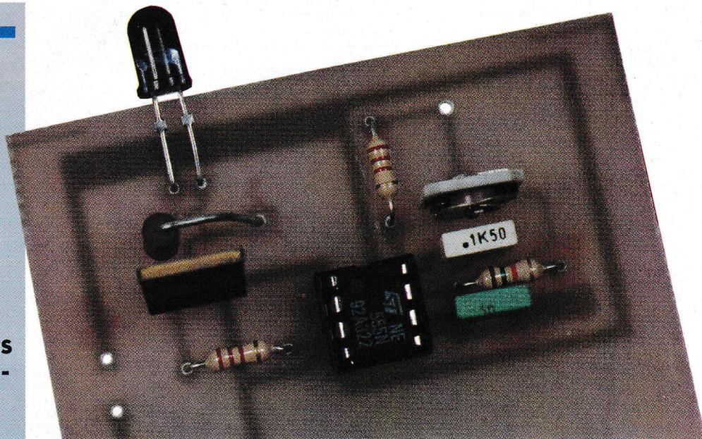
sortie est un simple transistor monté en inverseur. La sortie sera donc active lorsque le niveau logique sera à l'état bas. Il existe également des modules dont la sortie est active à l'état haut; ce sont les composants de la série TFMS 5..9.
