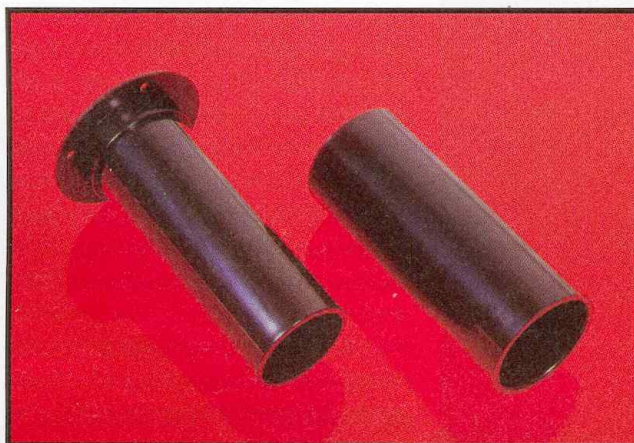
L'évent télescopique, le tube de gauche se monte sur celui de droite et la longueur totale s'ajuste. Un point de colle termine le montage.
