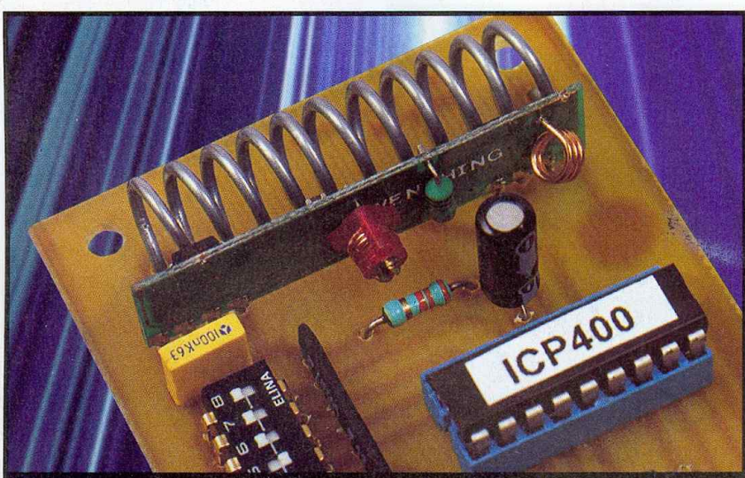
l'antenne comporte 11 spires de fil 12/10 e bobinés sur un Ø 7
