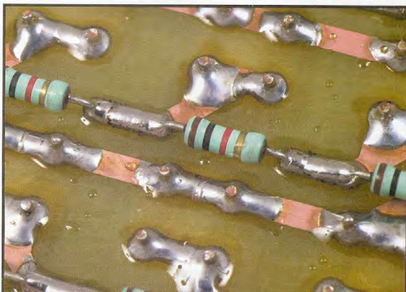
mise en place des résistances
