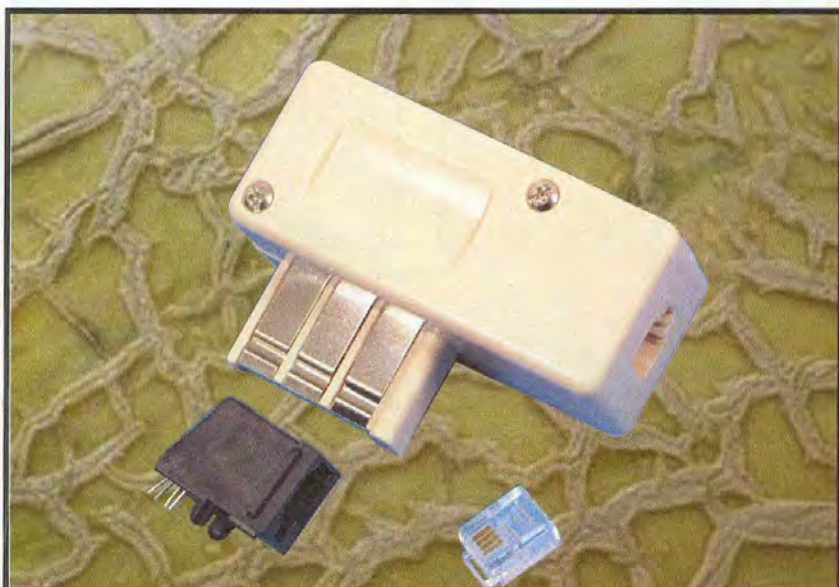
La connectique téléphonique des modems : prise gigogne et prise modular jack
