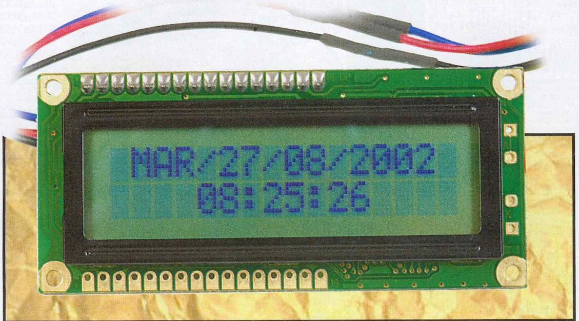
Pour doter une application PicBasic d'une horloge temps réel, on pourra très simplement faire appel au circuit intégré DS1302 de DALLAS Semiconductor. Le Coréen COMFILE propose une minuscule platine additionnelle appelée «RTCboard» qui comporte tous les composants nécessaires à cette extension haut de gamme, avec une facilité de mise en œuvre déconcertante.
