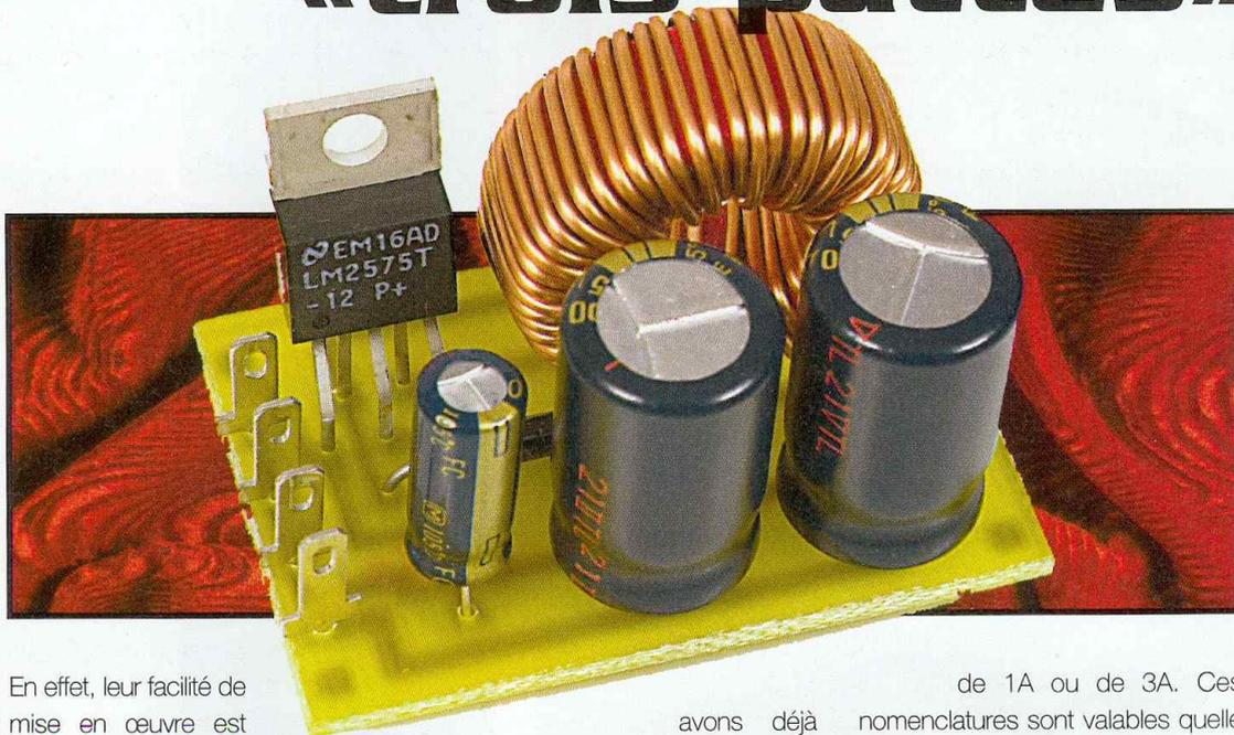
Lorsque l'on voit la simplicité de mise en œuvre des régulateurs à découpage de type «simple switchers» de NS, telle que vous avez pu la découvrir si vous avez lu notre article consacré au calcul des alimentations à découpage, il vient immédiatement à l'esprit l'idée de les utiliser à la place des classiques régulateurs «trois pattes».
