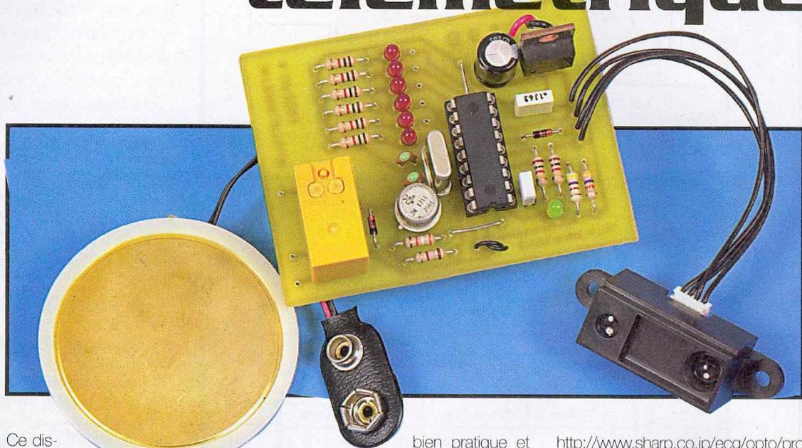
Exploitant le capteur télémétrique GP2002 à infrarouge de chez SHARP, ce montage propose deux fonctions. D'une part, il fonctionne comme un simple interrupteur et offre les deux fonctions marche/arrêt sur le même faisceau. Cette particularité permet une multitude d'utilisations. Très pratique, surtout lorsque l'on a les mains chargées et que l'on souhaite actionner un interrupteur sans avoir à viser un bouton précis.
