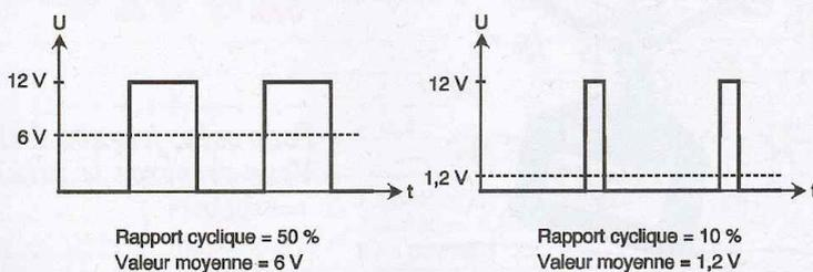
**1** Principe du hacheur
