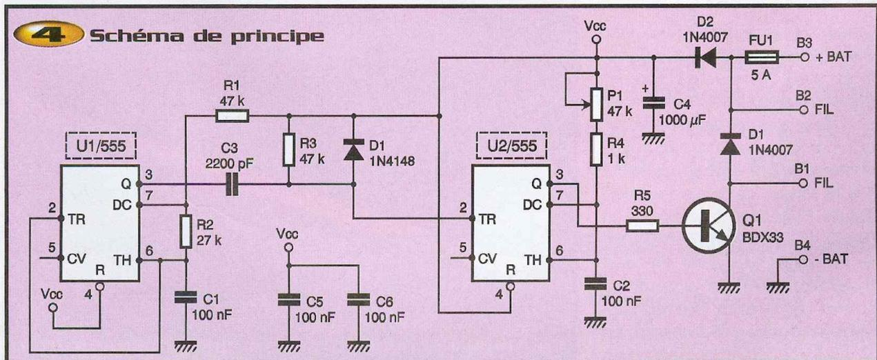
comme la diode d'un redressement mono alternance et  $C_4$  joue le rôle du condensateur de filtrage. Quant au fil chaud, il s'accommodera parfaitement d'une tension simplement redressée et hachée.
