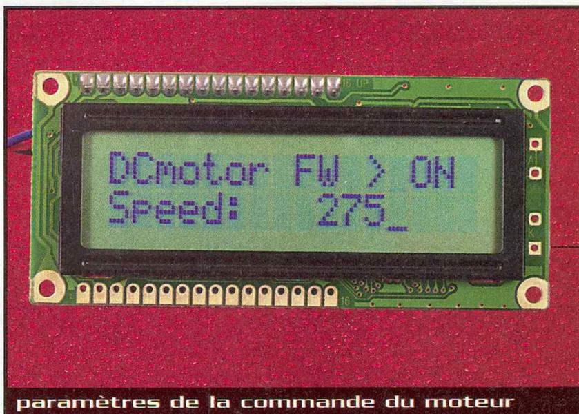
paramètres de la commande du moteur
