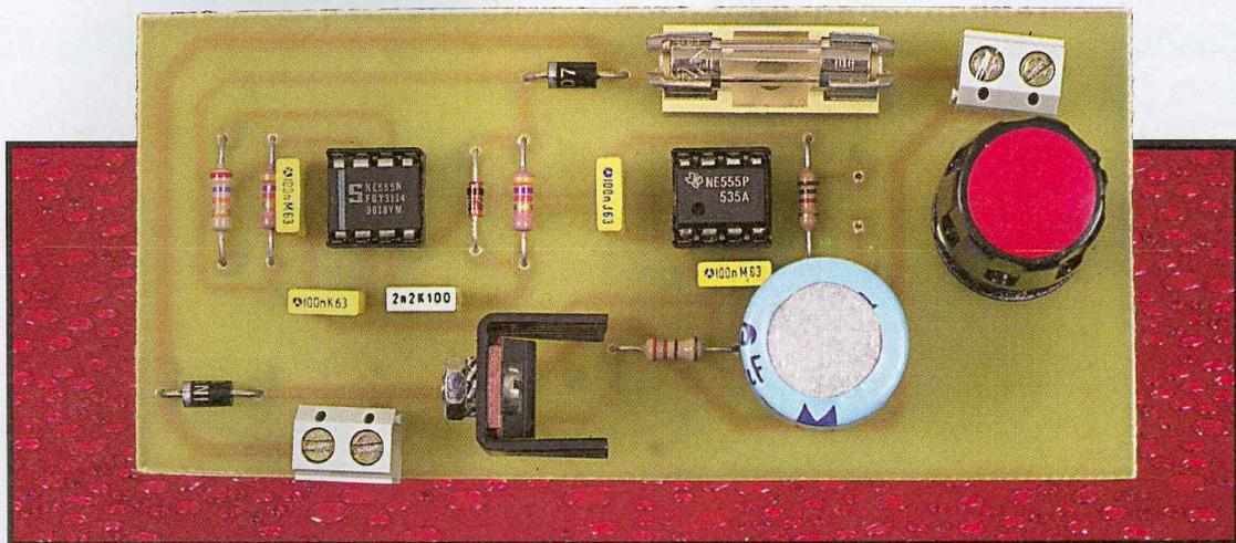
Il ne s'agit pas là d'un fil à couper le beurre, encore que... Le fil chaud est très utilisé en modélisme pour découper des formes en polystyrène. Le module que nous vous proposons de réaliser permet de contrôler la température de ce fil. Il pourra aussi vous servir pour contrôler la vitesse d'un petit moteur à courant continu, du genre de ceux utilisés dans les mini-perceuses ou en robotique.
