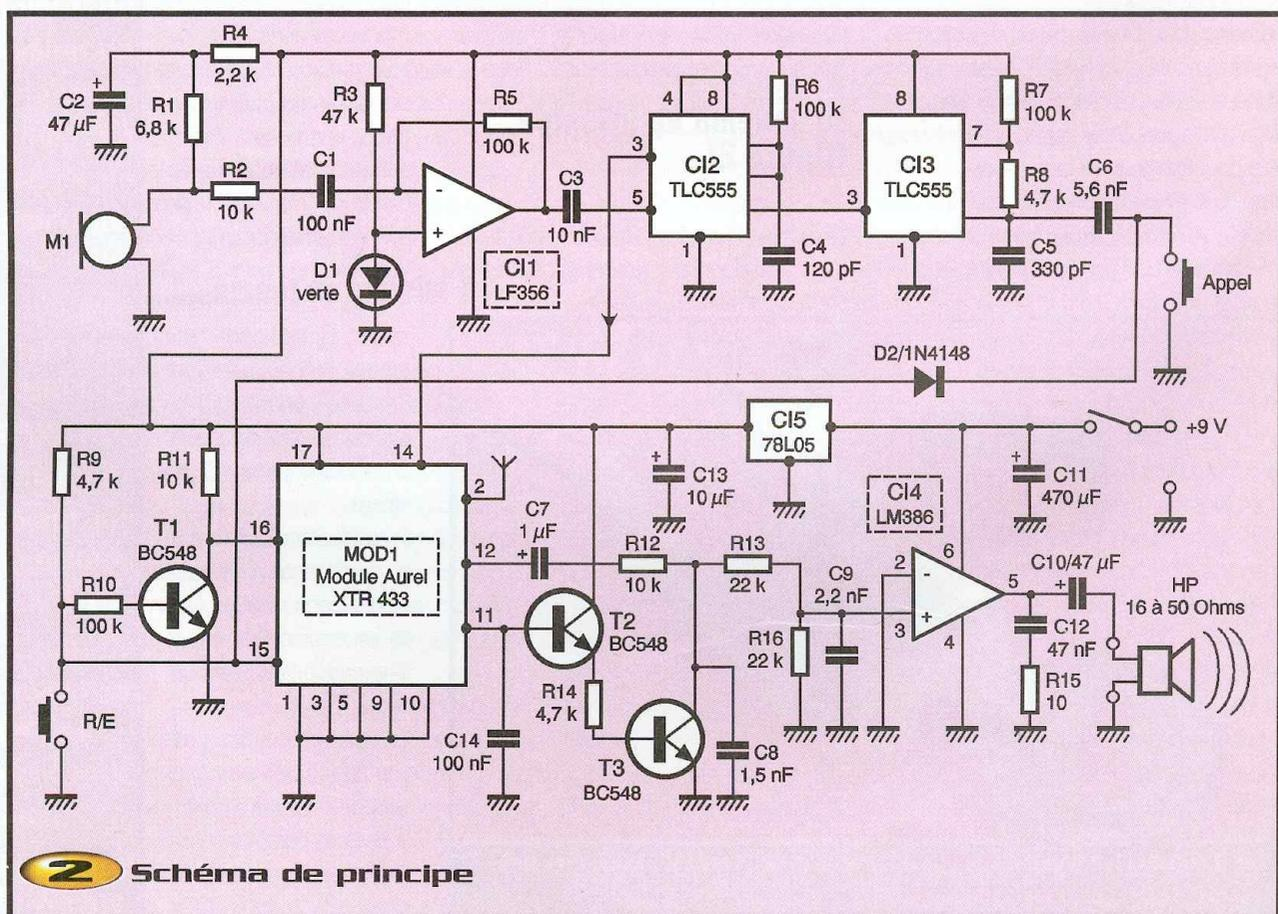
**2** Schéma de principe
