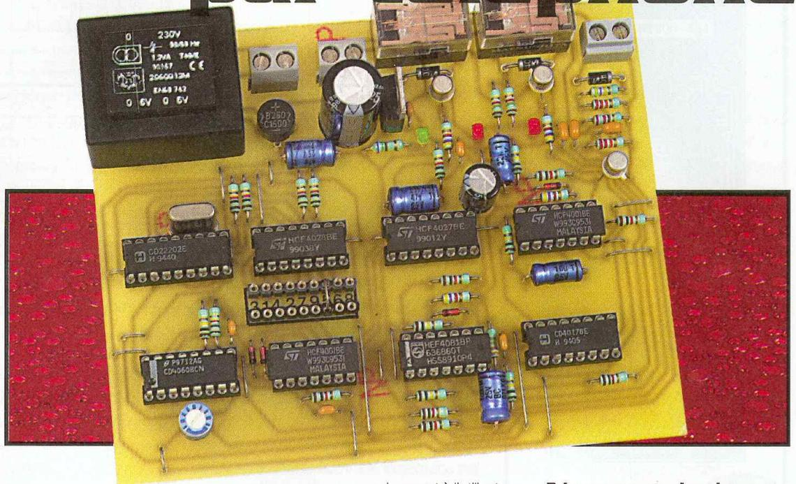
Grâce à ce montage, il vous sera possible de commander, même de très loin, à partir d'un téléphone fixe ou encore d'un portable, toutes sortes de fonctions dans une maison ou un appartement. Par exemple, la mise en route ou l'arrêt du chauffage ou encore l'allumage ou l'extinction d'un éclairage rentrent sans problème dans les possibilités de cet appareil.
