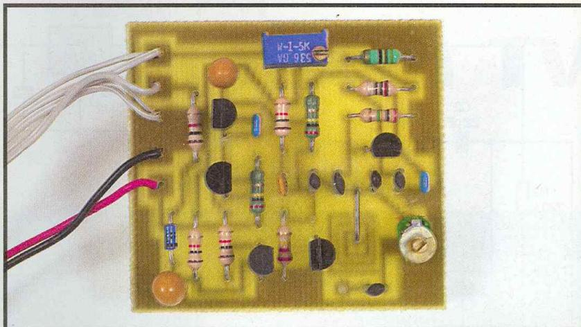
**l'émetteur FM équipé d'un oscillateur Colpitts**
