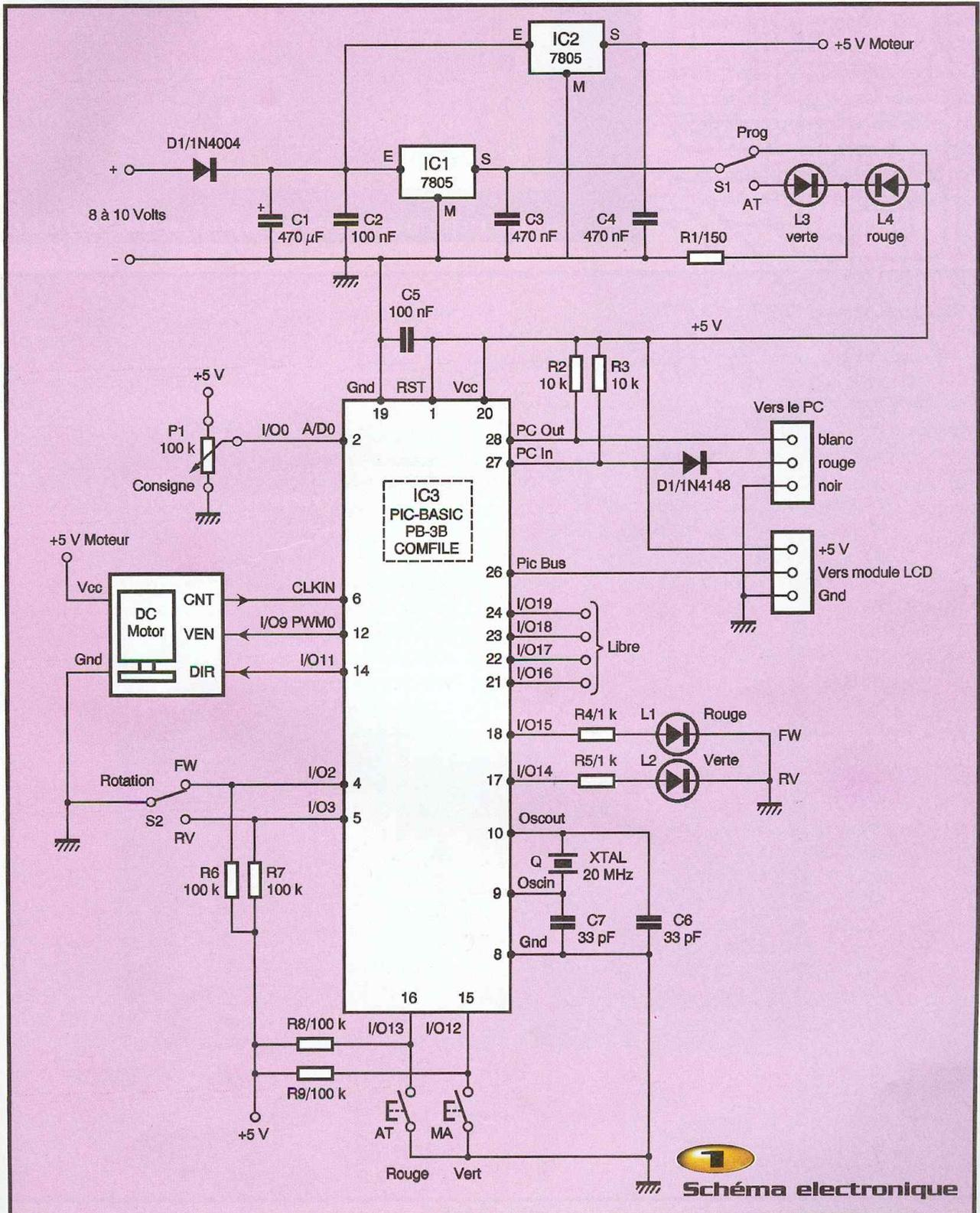
linéaire. Les deux poussoirs AT et MA sont reliés respectivement sur les entrées I/O 13 et 12, avec l'aide des résistances de polarisation  $R_8$  et  $R_9$ . De même, l'inverseur  $S_2$  vous permettra de choisir le sens de rotation du moteur sur l'une des entrées I/O 2 ou 3. Deux diodes électroluminescentes, rouge et verte, peuvent faire office de signalisation si vous ne souhaitez pas mettre en œuvre l'afficheur LCD.
