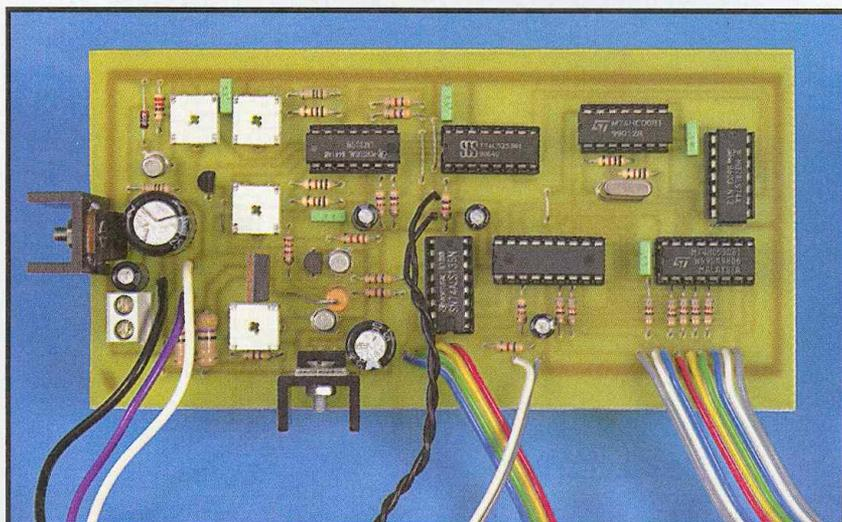
le module principal équipé d'un PIC 16F84
