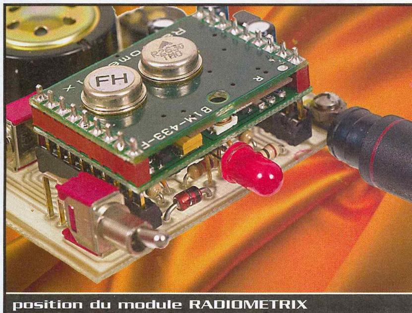
position du module **RADIOMETRIX**
