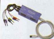
**Optascope 81M** : L'OPTAscope est un oscilloscope numérique se connectant sur le port USB d'un
