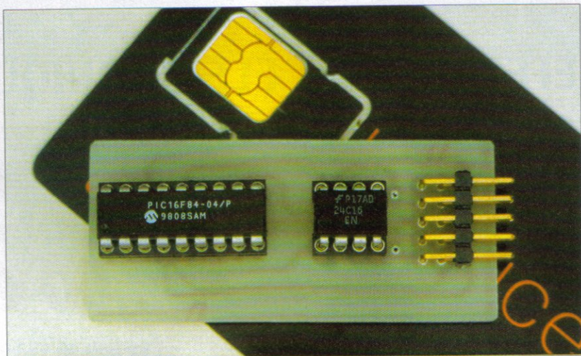
Interconnexions entre un PIC et une EEPROM
