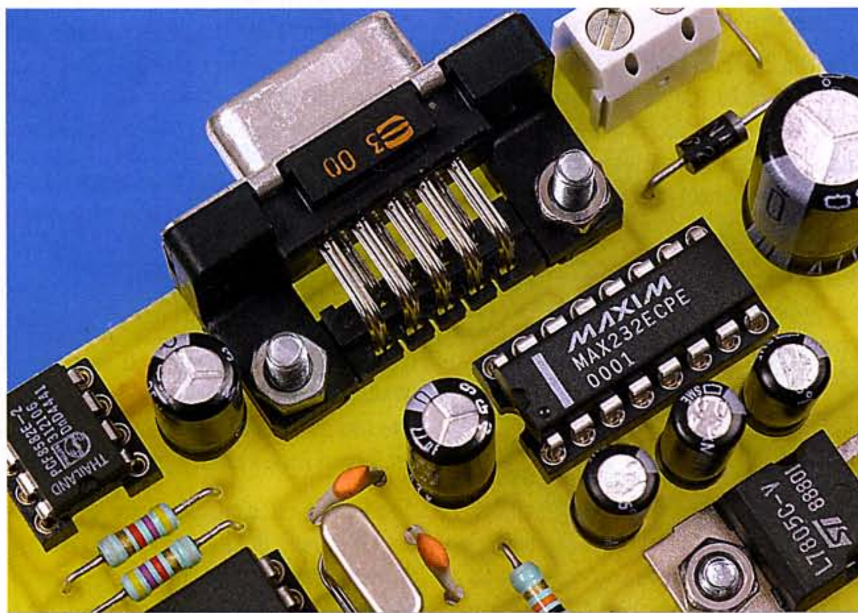
Le MAX 232 adapte les niveaux des signaux RXD et TXD
