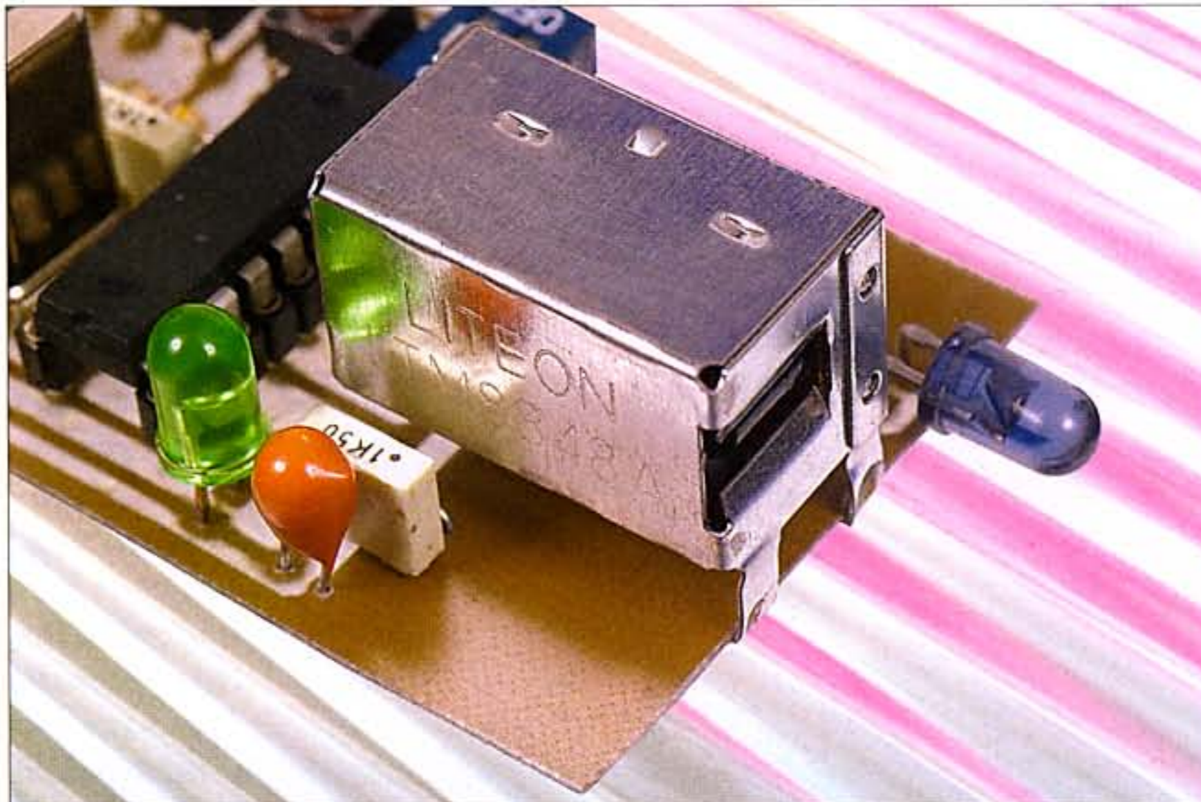
La diode réceptrice est enfermée dans un boîtier métallique
