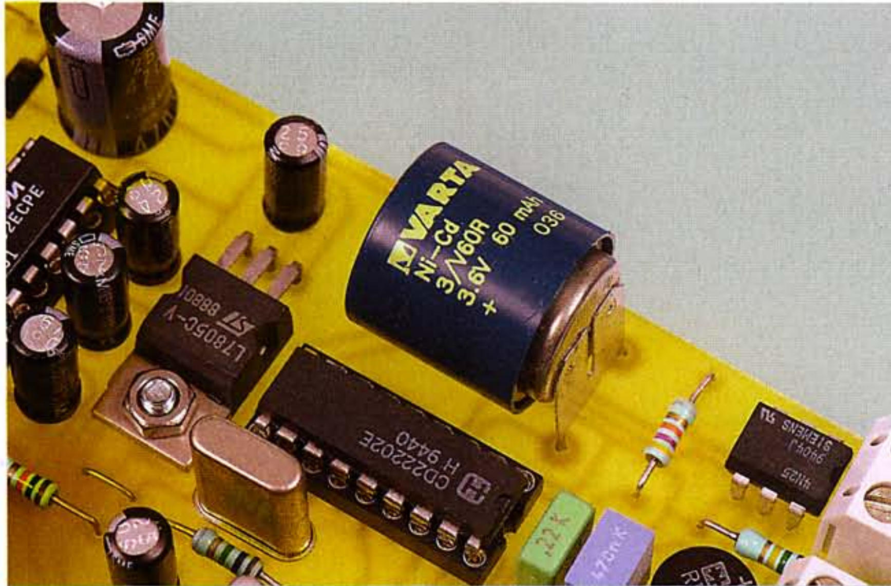
Décodage des signaux DTMF par un circuit CD2220 2E
