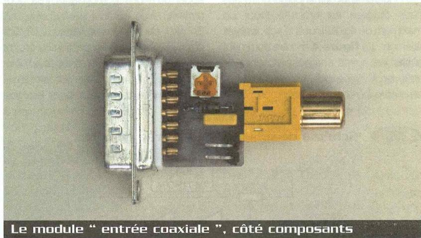
Le module " entrée coaxiale ", côté composants
