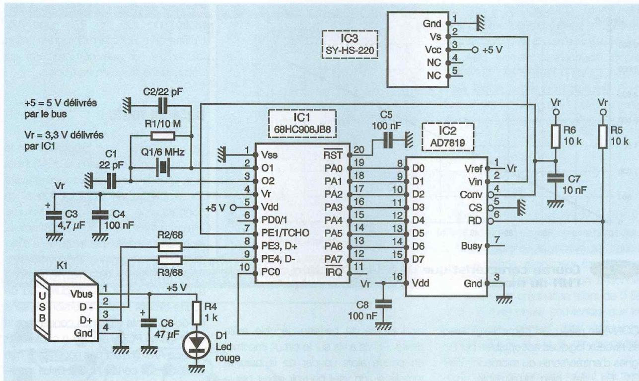
**1** Schéma de principe de l'hygromètre USB
