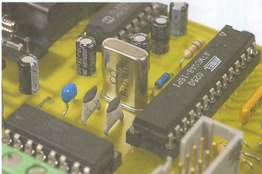
Notre alarme prévient par téléphone que l'une de ses quatre entrées a été électriquement fermée ou ouverte, selon le mode avec lequel elle a été paramétrée au moyen d'un ordinateur PC. En cas de non réponse, l'alarme peut appeler un autre numéro. Jusqu'à huit numéros sont ainsi programmables, chacun d'eux pouvant être affecté à tout ou partie des quatre entrées. Bien entendu, l'alarme informe le correspondant sur quelle(s) entrée(s) est motivé l'appel.
