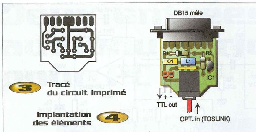
intérêt aux solutions concurrentes. Le schéma de la **figure 2** est ainsi basé sur le récepteur Ref. 4189-2, qui nécessite une tension d'alimentation de 3 volts, impeccablement découplée. La mise en oeuvre pratique que nous avons imaginée fait appel à une fiche DB15 mâle, qui sert essentiellement à prélever du 5 volts sur la prise "Joystick" dont sont équipées la plupart des cartes "son".
