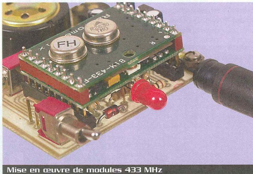
Mise en œuvre de modules 433 MHz
