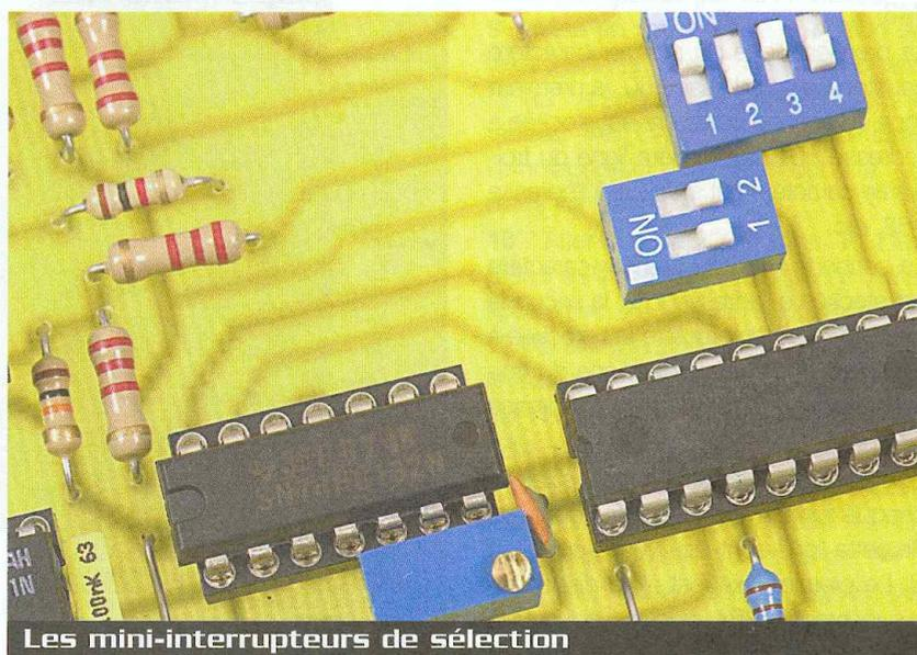
Les mini-interrupteurs de sélection
