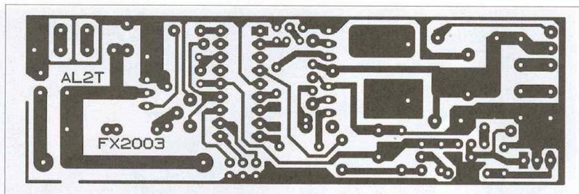
**8** Tracé du circuit imprimé
