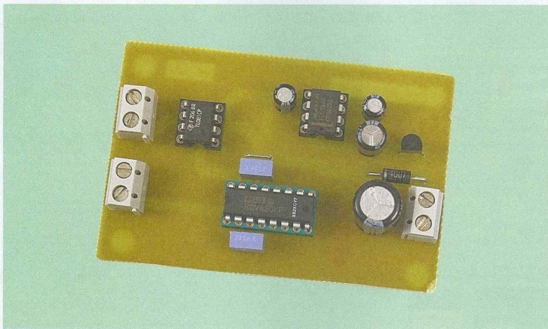
Lorsque l'on souhaite transmettre une tension analogique (par exemple la tension de sortie d'un capteur) sur une longue distance on est souvent amené à utiliser une liaison 4/20 mA. Cette solution évite d'avoir à numériser le signal dès le départ ce qui est généralement plus coûteux car les contraintes d'encombrement sur le terrain sont parfois sévères et les sources d'alimentation peu nombreuses.
