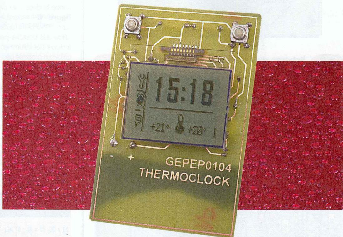
**Thermoclock vous propose d'exploiter un mini écran graphique pour afficher l'heure ainsi que deux températures prises en deux endroits différents. L'ensemble est réglable à l'aide de boutons poussoirs qui vous permettent de naviguer sur différents écrans pour effectuer vos réglages.**
