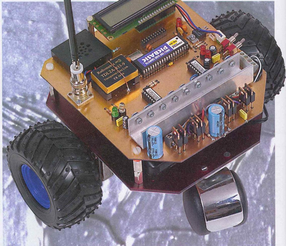
*Nos lecteurs étant toujours très intéressés par la robotique, nous proposons dans cet article la réalisation d'une base de robot mobile. Cette base, évolutive, est télécommandée au moyen d'un modem radio par un ordinateur de type PC. De conception mécanique et électronique très simple, elle peut être réalisée par tous.*
