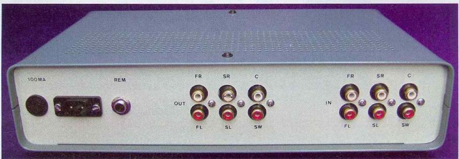
Photo 4 : Face arrière du préamplificateur muni de ses diverses prises de raccordements
